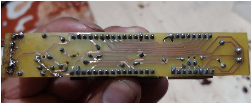
Anexo 17: Suelda de pistas de los componentes.
