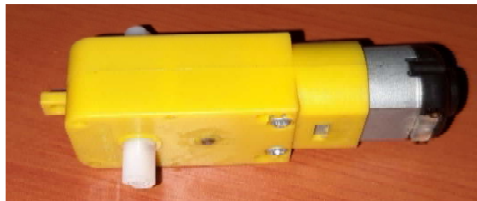
Anexo 2: Micromotor con caja reductora plástica.
