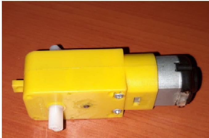
Figura 8: Micromotor con caja reductora plástica.
