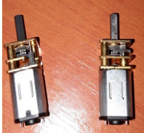
Figura 7: Micromotor 50:1HP con caja reductora metálica.
