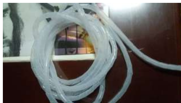
Figura 33: Protección de cables. Elaboración propia. (2019).
