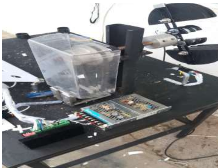
Figura 30: Montaje de driver, fuente, motor, y protección de poleas. Elaboración propia. (2019).
