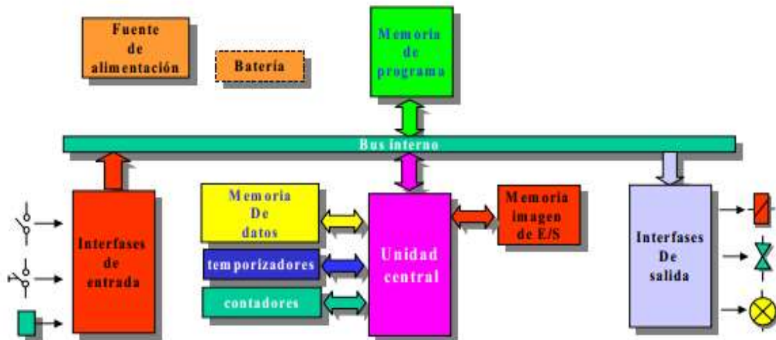
Figura 5. Diagrama estructura interna de un PLC. (2018) Recuperado de: https://docplayer.es/7966272-Universidad-veracruzana-facultad-de-ingenieria-ciudad-mendoza-ver.html
