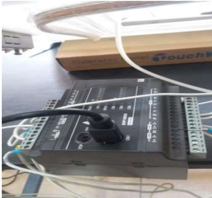
Figura 29: Conexiones del PLC. Elaboración propia. (2019).
