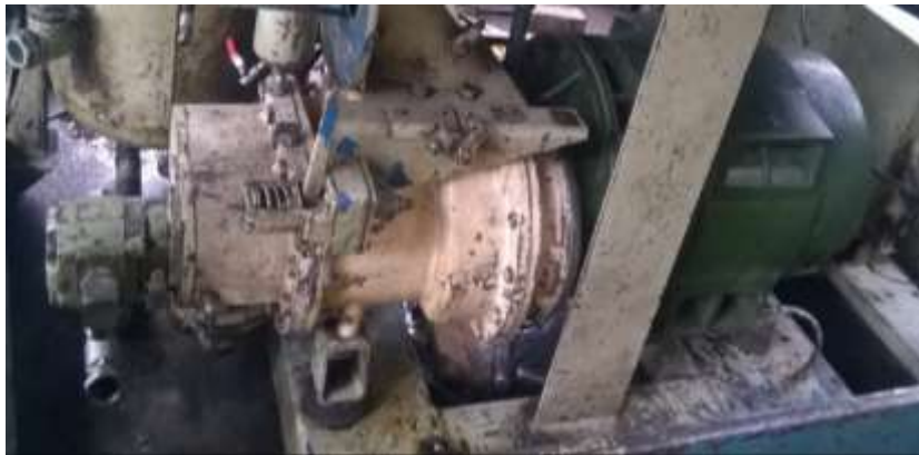
Figura 17: Unidad de compresor sin mangueras hidráulicas. Fuente propia (2018)
