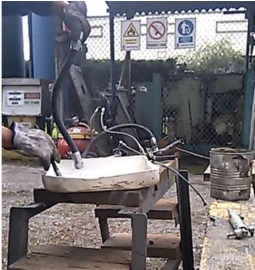
Figura 38: Limpieza de mangueras y válvulas hidráulicas. Fuente propia (2018)
