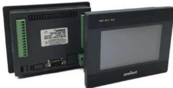
*Nota.* Elemento de control PLC con HMI integrado, imagen extraída del sitio web “aliexpress.com” marzo de 2023.
