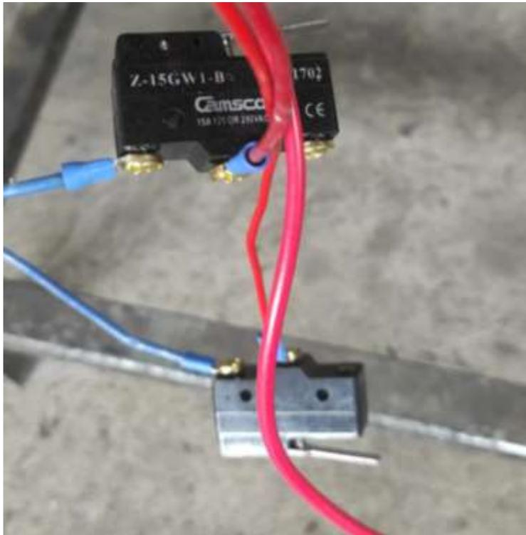
*Nota.* Realización de las pruebas de funcionamiento de los sensores de contacto
