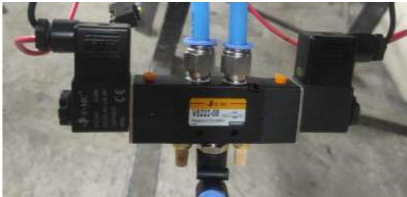
*Nota.* Realización de las pruebas de las electroválvulas conectadas a 24 VCC.
