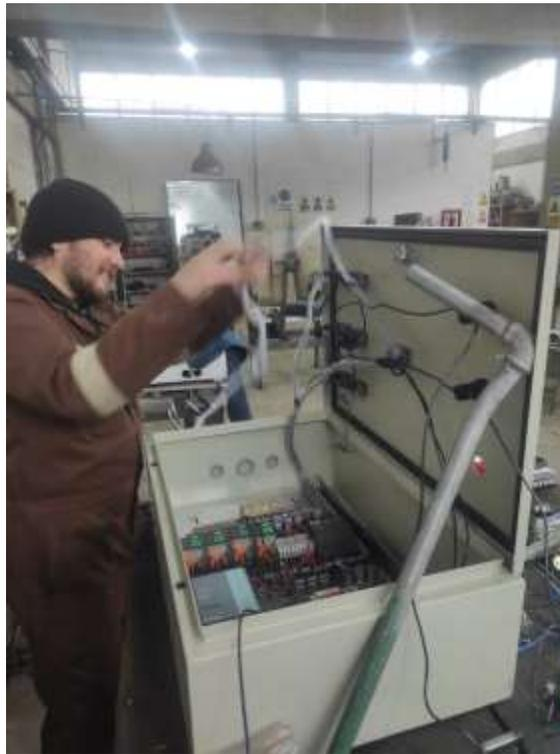
*Nota.* Realización de las conexiones internas de los elementos de control ubicados en el tablero eléctrico.
