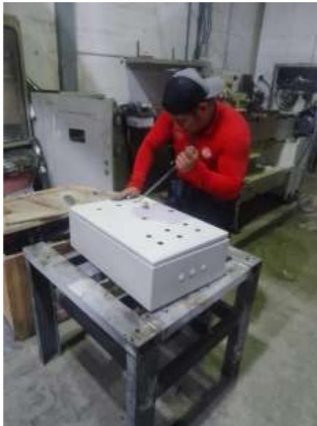
*Nota.* Realización de perforaciones para la colocación de luces piloto, pulsadores y paro de emergencia.
