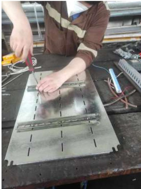
*Nota.* Colocación de rieles DIN y canaletas para la ubicación y cableado de los elementos de control.
