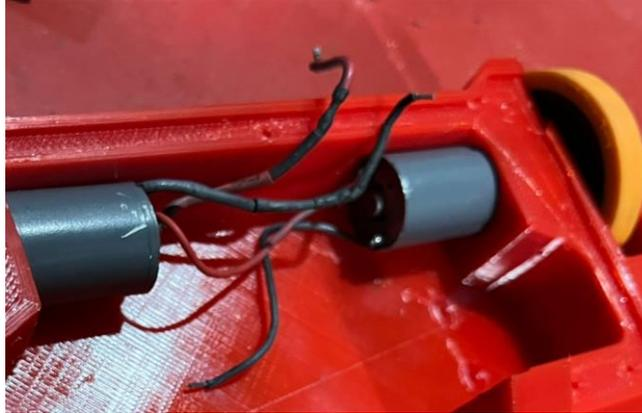
*Nota.* El motor pololu consta de las siguientes constantes en su funcionamiento, voltaje=12V, no-load performance=500RPM, 250mA y stall extrapolation=7,4kg.cm (100 oz.in), 5A.
