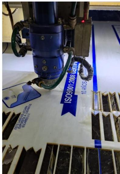
*Nota:* Corte del soporte de los sensores en la máquina laser. Elaboración propia.
