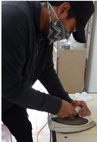
Nota: Impresión de Ruteo de pistas en PCB mediante planchado. (Meneses S., 2022)
