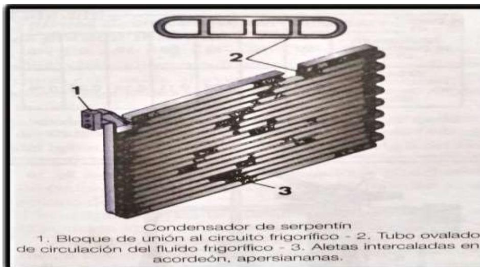
*Nota.* Condensador tipo serpentín. Tomado de “Adaptación e implementación de un sistema de aire acondicionado y calefacción para evitar el empañamiento de los vidrios en la camioneta Chevrolet D-Max 3.0 CRDI” (p. 16), por A. Hidrobo, 2018, (<https://repositorio.uide.edu.ec/bitstream/37000/2823/1/T-UIDE-2002.pdf>).
