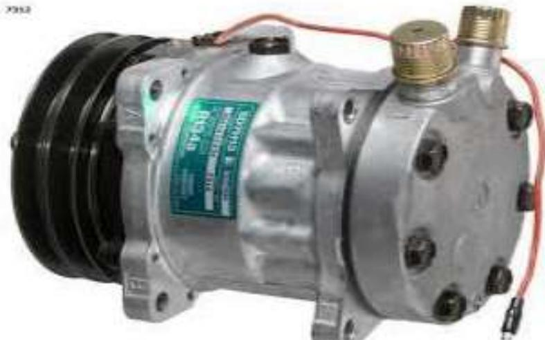
*Nota.* Compresor de aire acondicionado. Tomado de Evaluación energética del sistema de aire acondicionado automotriz basado en la primera y segunda ley de la termodinámica para un Renault Twingo (p. 18), por F. Ocampo, J. Arango, J. Gonzales 2018.
