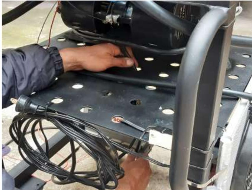
Con respecto al resto de conexiones eléctricas del sistema se las realizó a 12V, mediante cable 16 para proteger la consola del aire acondicionado se colocó un fusible de 15A, para proteger todo el sistema de aire acondicionado se colocó dos relay de 30A, El cable negativo de la batería se conectó en la parte central de la consola del aire acondicionado, como se muestra en la figura 34.
