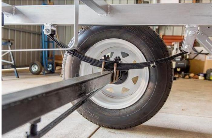
*Nota.* Colocación de las suspensiones tipo ballesta.
