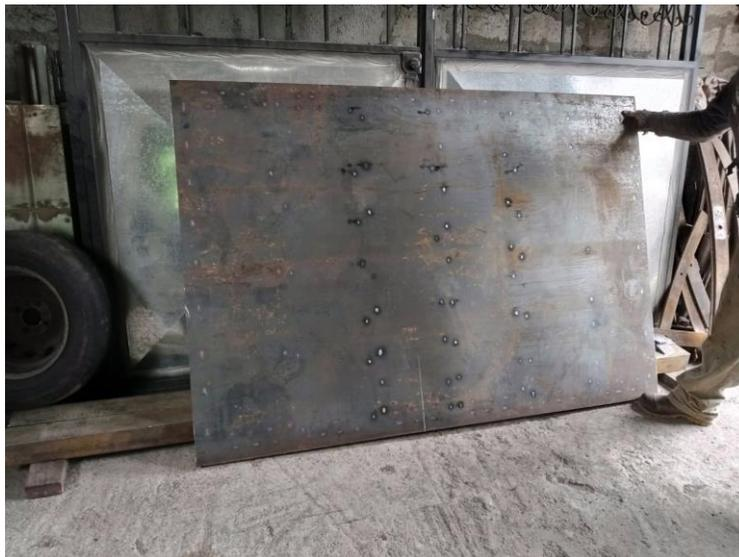
*Nota.* Plancha metálica para el remolque.
