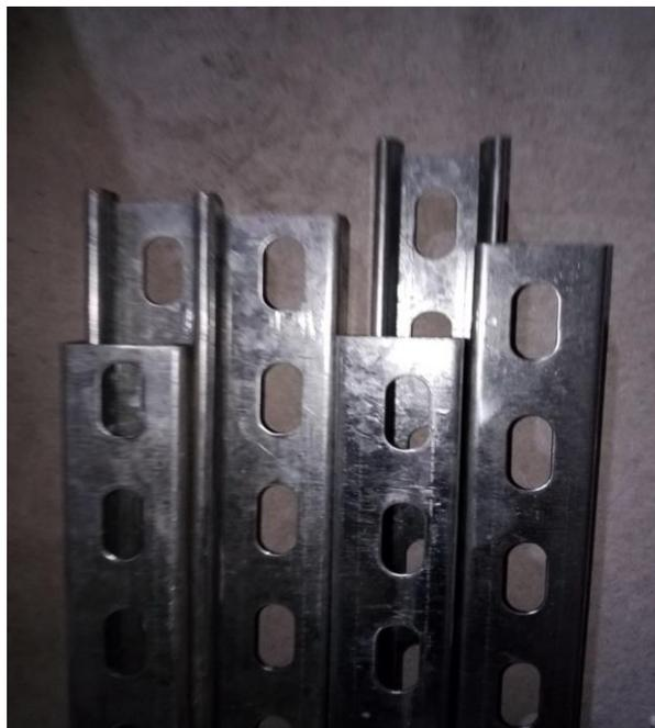
*Nota.* Vigas de soporte del evaporador.
