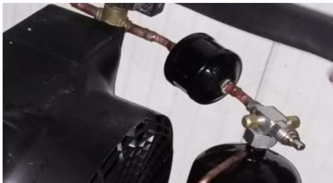
*Nota.* Ubicación de filtro y válvulas para el sistema de enfriamiento.
