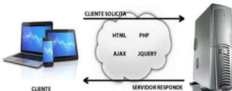
*Nota.* La figura muestra la estructura del funcionamiento de cliente/servidor. Fuente: Carlos E. Muñoz (20214).
