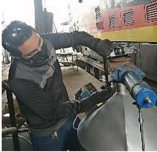
Imagen No. 25 Ajuste del acoplamiento de la válvula. Elaborado por: Paul Fernando Naranjo Torres Fuente: Propia.
