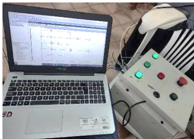
Imagen No. 38 Programación del PLC Logo! 230RCE. Elaborado por: Paul Fernando Naranjo Torres Fuente: Propia.
