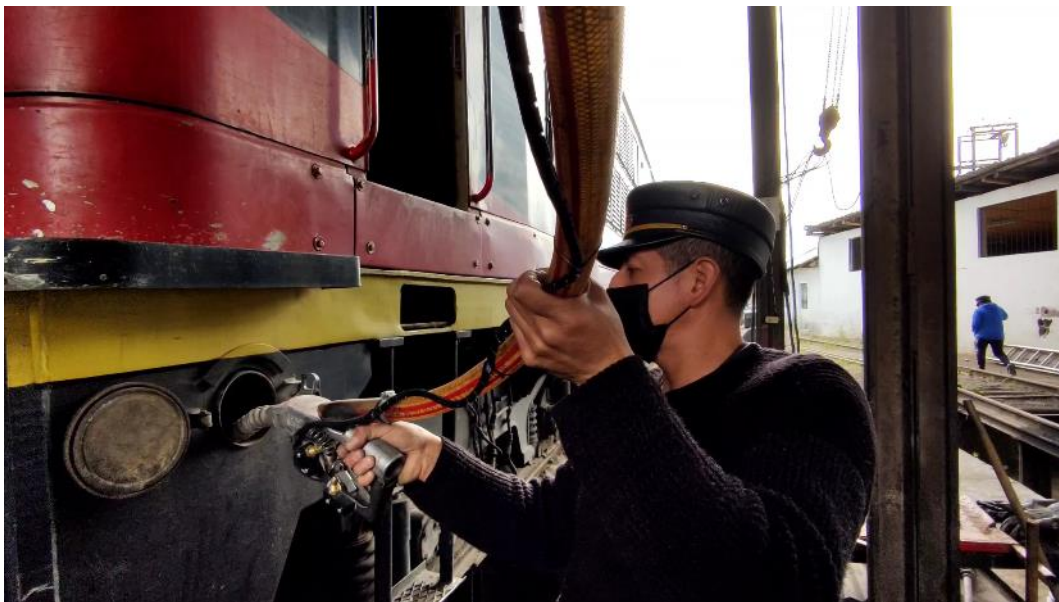
Anexo No. 13 Ubicación del operador surtidor de arena Elaborado por: Paul Fernando Naranjo Torres Fuente: Propia
