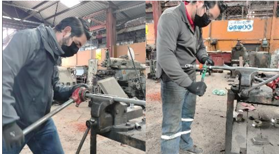
Imagen No. 32 Elaboración de roscas para la tubería principal de aire. Elaborado por: Paul Fernando Naranjo Torres Fuente: Propia.
