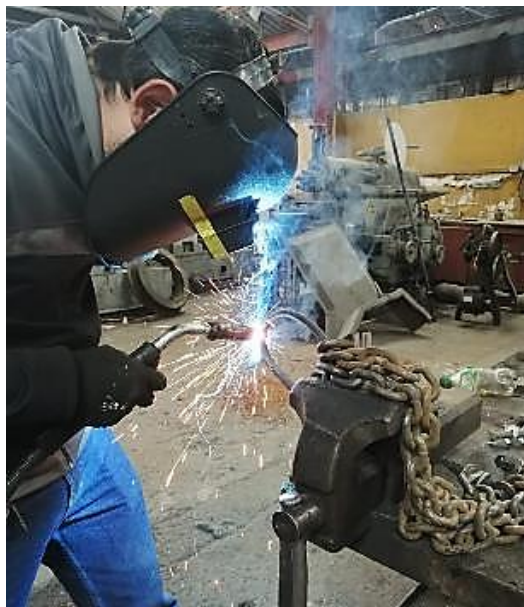
Imagen No. 28 Construcción del eslabón principal. Elaborado por: Paul Fernando Naranjo Torres Fuente: Propia.
