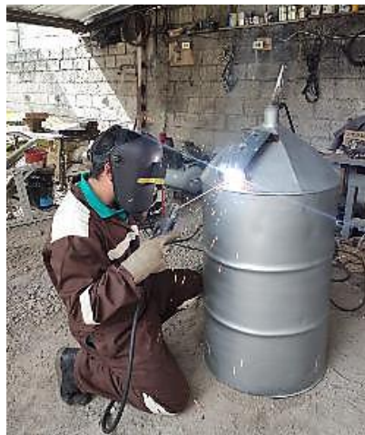
Imagen No. 19 Soldadura de la base del motor vibrador. Elaborado por: Paul Fernando Naranjo Torres Fuente: Propia.
