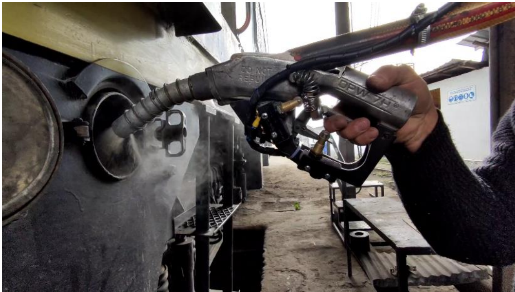
Anexo No. 14 Activación del micro interruptor de inicio de carga Elaborado por: Paul Fernando Naranjo Torres Fuente: Propia
