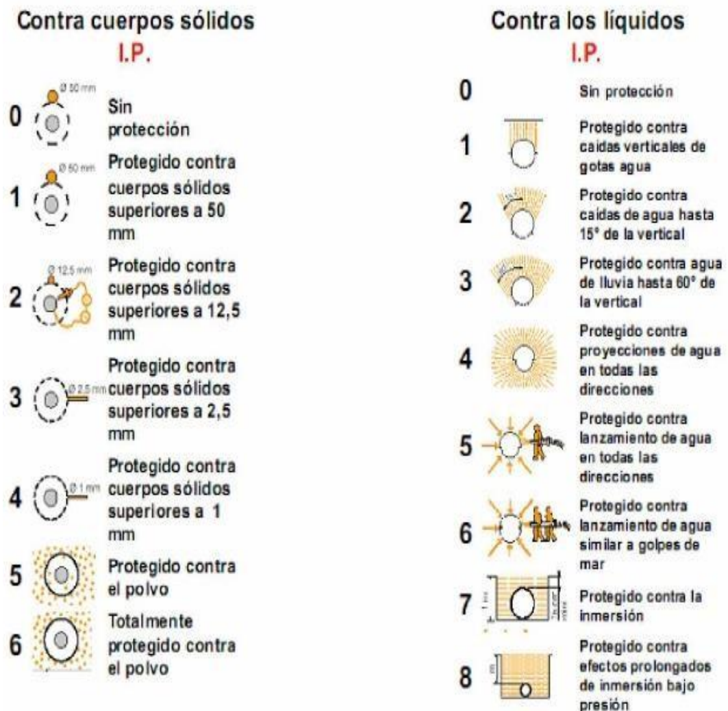
Gráfico No. 8 Grado de protección IP Elaborado por: León, J y Ovalle, R. Fuente: Dspace.utb.edu.ec
