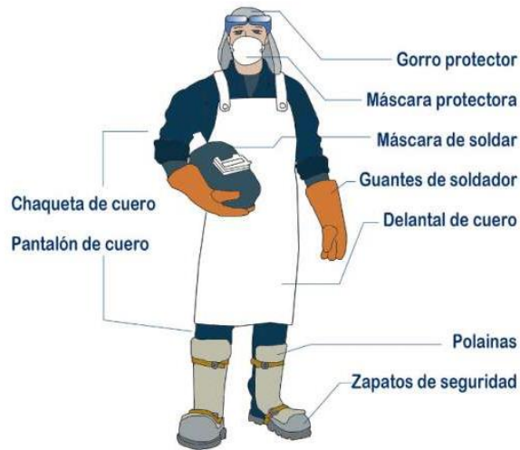
Gráfico No. 2 Seguridad durante los trabajos de soldadura Elaborado por: Kemppi Fuente: www.kemppi.com
