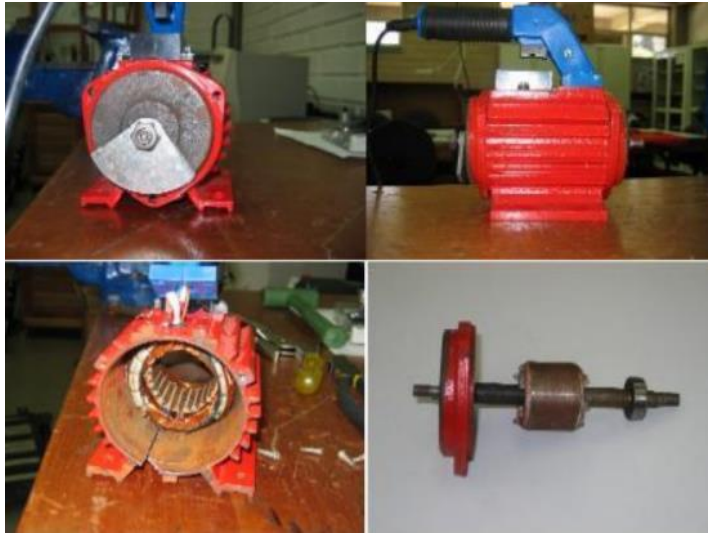
Imagen No. 6 Despiece del Motovibrador Elaborado por: Restrepo, Alejandro (2006) Fuente: https://repository.eafit.edu.co
