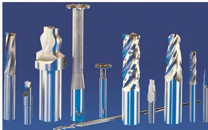
**Imagen No. 2** Herramientas de corte rotativas de acero rápido
