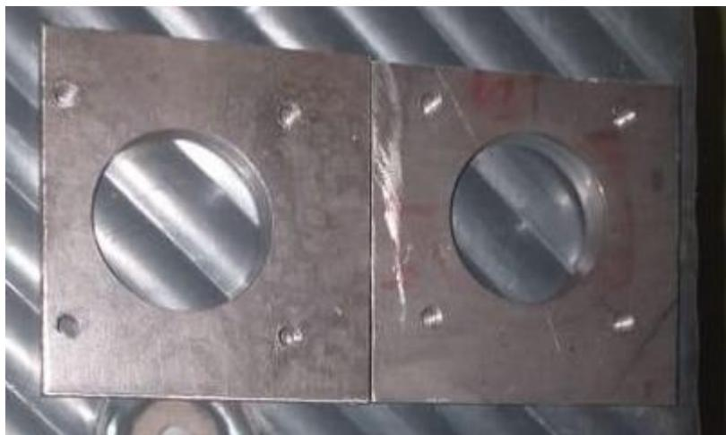
**Imagen No. 19** Placas de soporte de los motores
