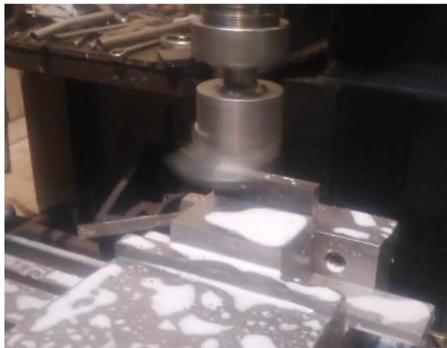
**Imagen No. 22** Fresado de dados de sujeción
