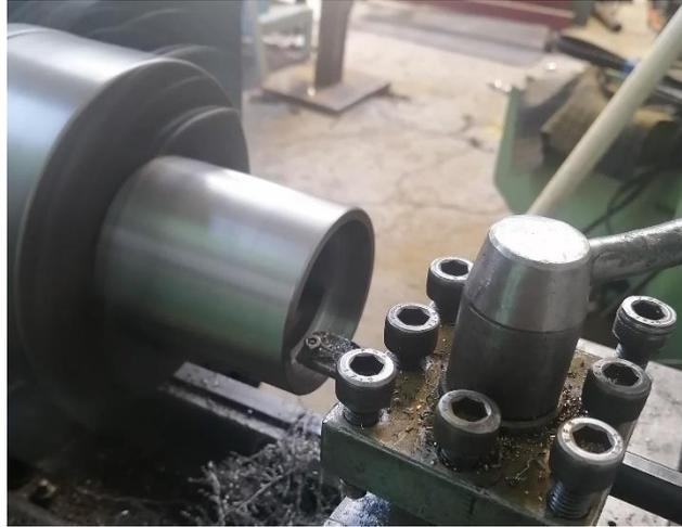
**Imagen No. 24** Maquinado de soporte portaherramientas
