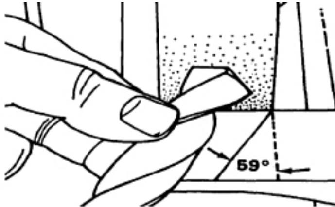
**Imagen No. 6** Proceso de afilado manual de una broca
