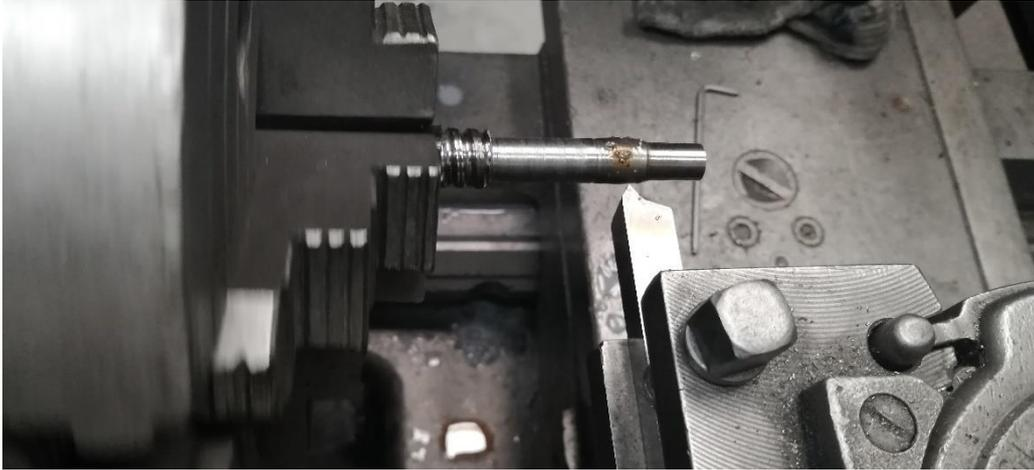
**Imagen No. 21** Roscado de punta de tornillo de bolas
