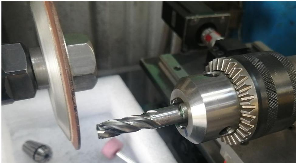
**Imagen No. 40** Afilado de talón de la fresa
