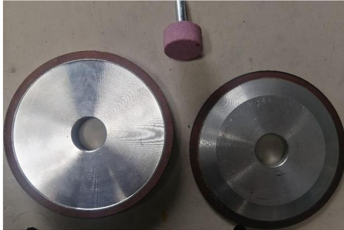
**Imagen No. 42** Tipos de abrasivos de diamante
