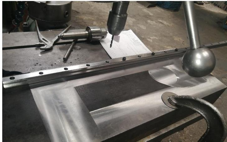
**Imagen No. 15** Perforación en taladro de pedestal de placa general
