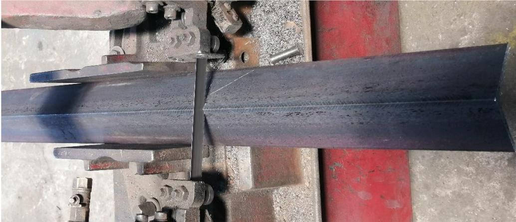
**Imagen No. 26** Corte de material para base de afiladora
