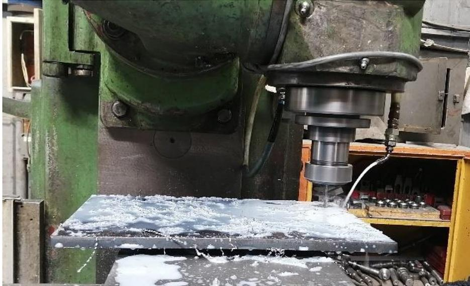
**Imagen No. 18** Perforación de placas, según planos
