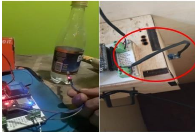
Imagen No. 42 Prueba del sensor IR FC-51 Elaborado por: Anthony Richard Gualotuña Rey Fuente: Datos de la investigación
