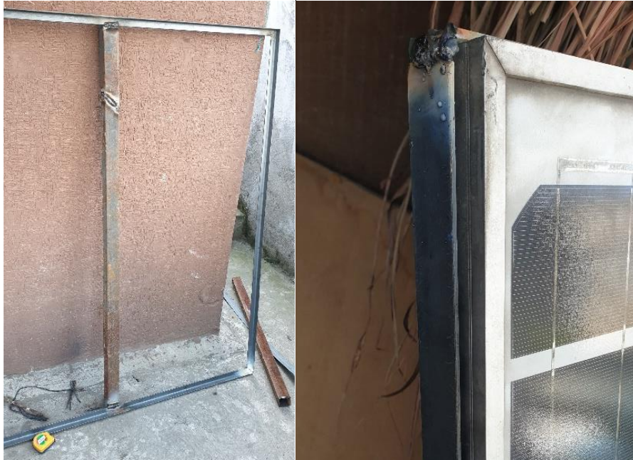
Imagen N° 18 Desbaste de la rebaba Elaborado por: Leonardo Romero Fuente: Elaboración Propia (2020)
