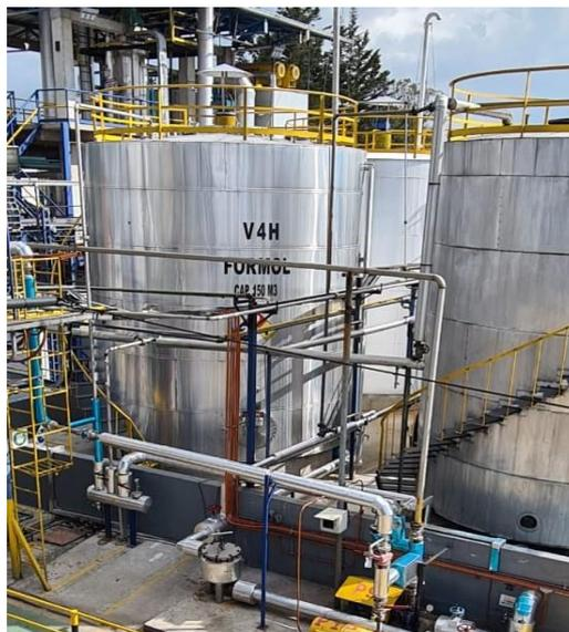
**Imagen No. 38** Tanque de Formol V4H
