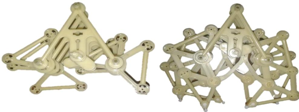
*Figura 23. Unión del trapecio con los soportes triangulares y los ejes de rotación*
