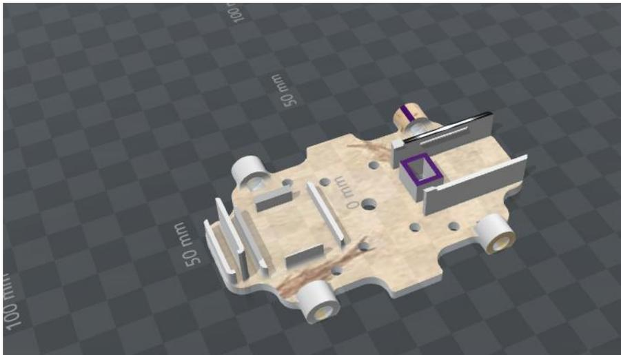
*Figura 18.* Construcción de la base en 3D
