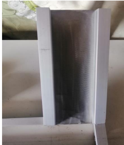
Figura 30: Rampa guía para recipientes.
