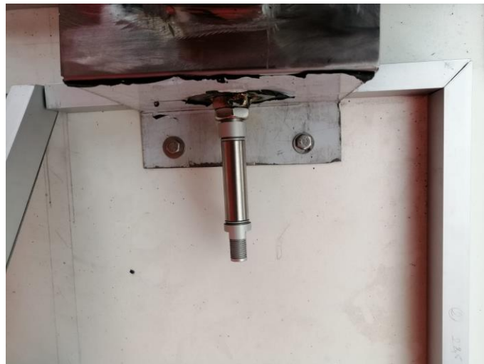
Figura 35: Soldadura de base la base para el cilindro de simple efecto.
