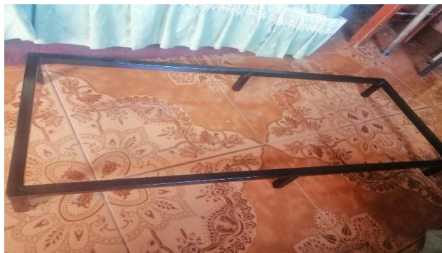
Figura 29: Estructura metálica para soporte de la base.
