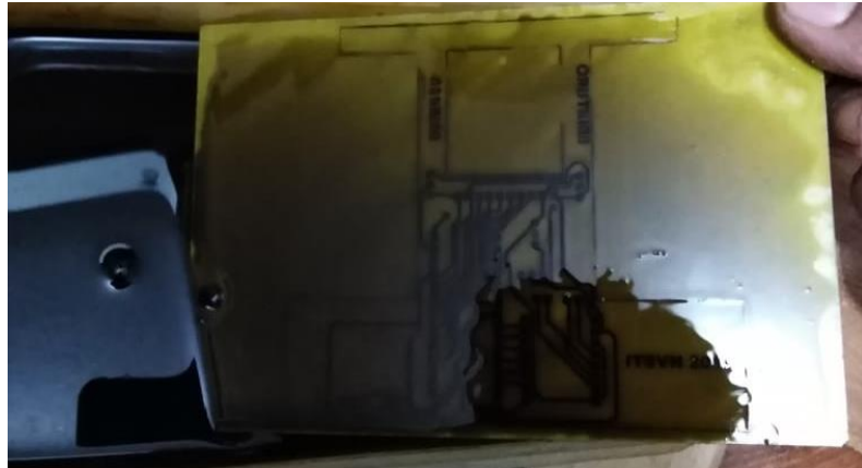
Figura 39. Baquelita en cloruro férrico Fuente: Elaboración propia (2019)
