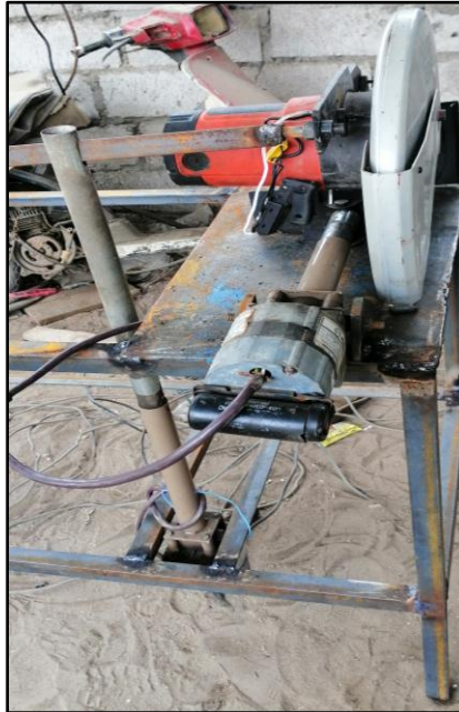
Figure 30: Adaptación de motor para brazo Elaboración propia. (2019).
