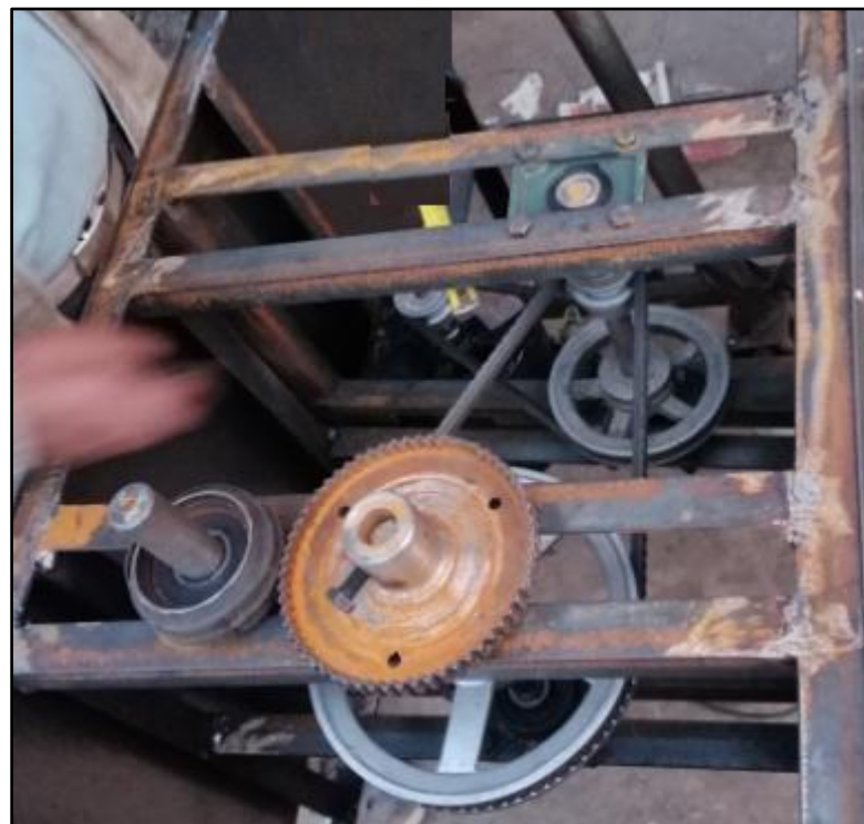
Figure 35: Colocación de coeas en la estructura de la máquina. Elaboración propia. (2019).
