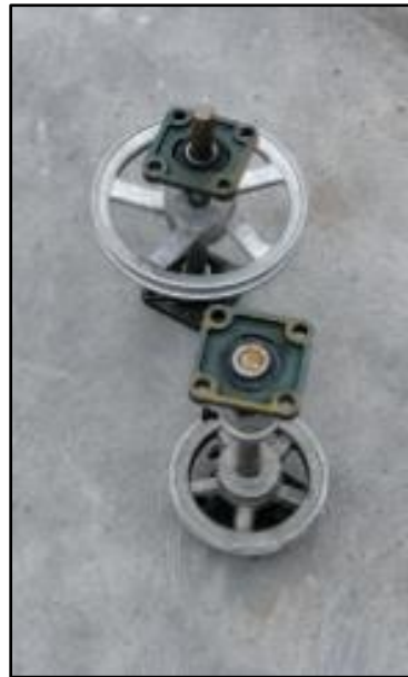
Figure 34: Armado de poleas y chumaceras. Elaboración propia. (2019).
