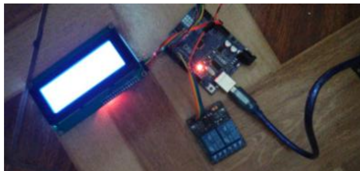
Figura 17: Conexión de la pantalla LCD con el Arduino Uno y los Relés Elaboración propia, (2019)
