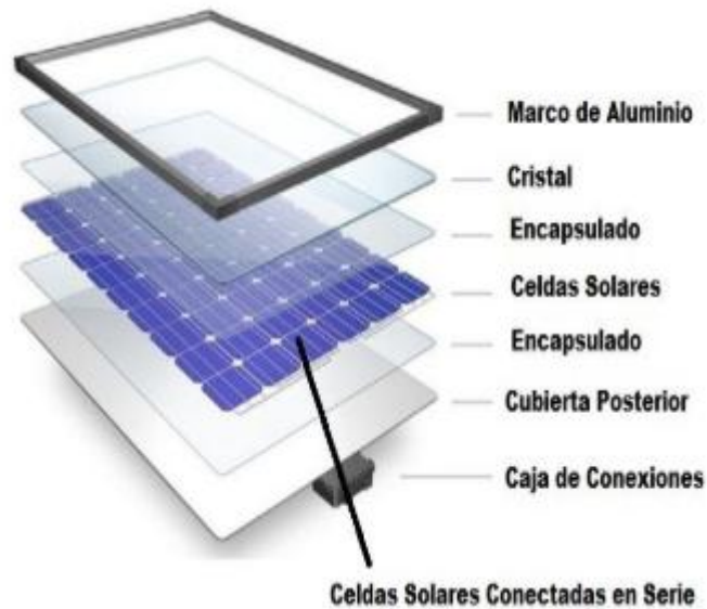
Figura 3 Partes del panel solar (Area Tecnologia , s.f.)
