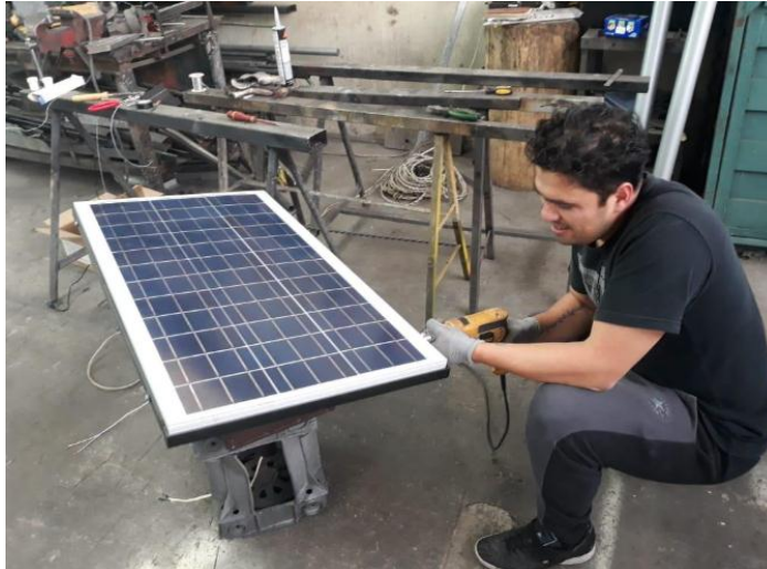
Figura 18: Colocación del panel solar en la estructura física (Elaboración propia, 2019)
