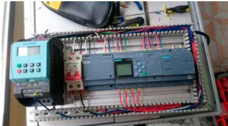
Figura 58. Conexiones eléctricas del módulo. Por Silva (2018)
