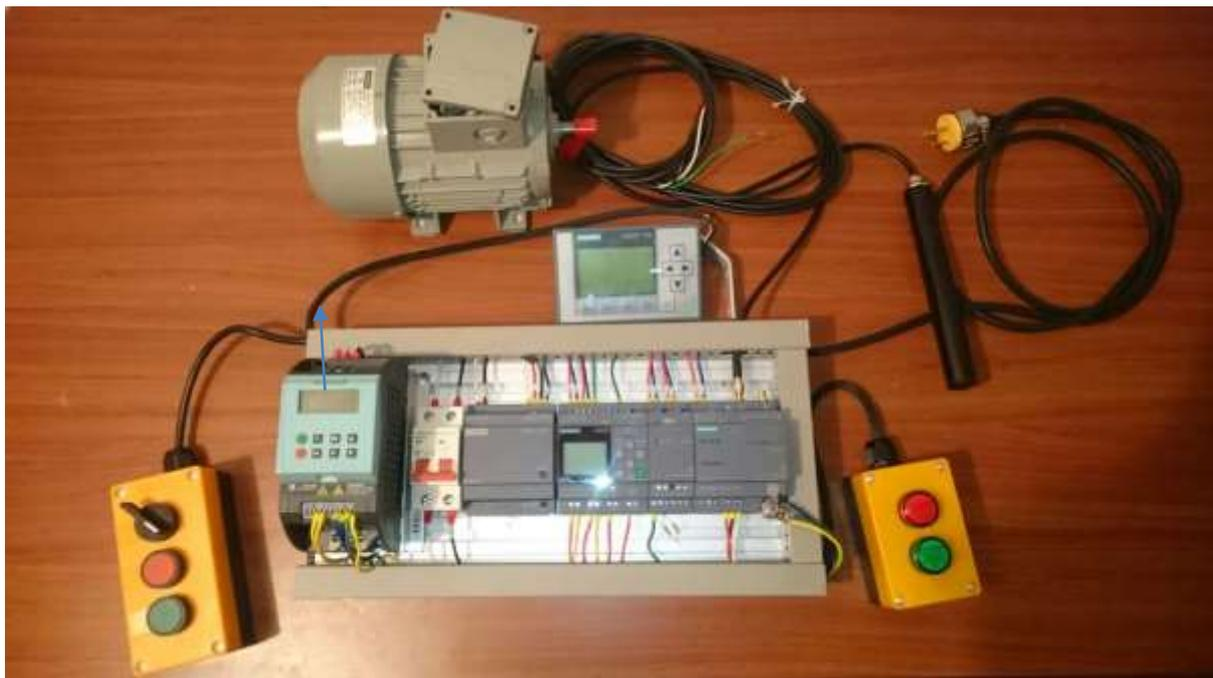
Figura 4. Ilustración de un módulo de monitoreo armado. Por Silva (2018)
