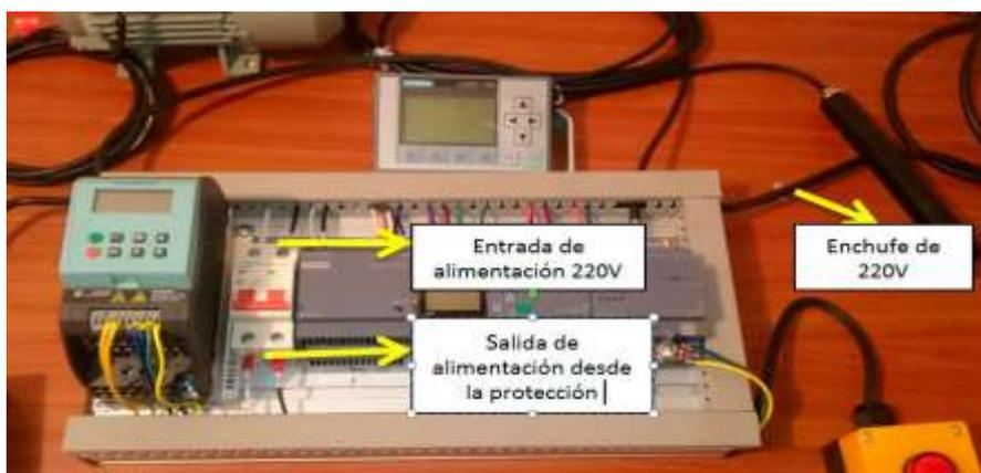
Figura 48. Conexión de alimentación general del módulo. Por Silva (2018)
