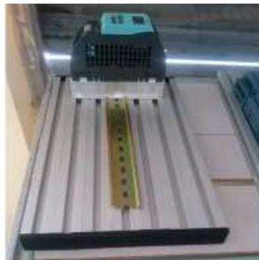
Figura 56. Ensamblaje de riel din a la base de aluminio. Por Silva (2018)
