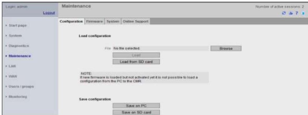
Figura 21. Cargar o guardar configuración. Por Zabala (2016)
