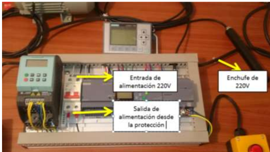
Figura 53. Conexión de alimentación general del módulo
