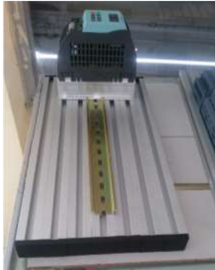
Figura 61. Ensamblaje de riel din a la base de aluminio
