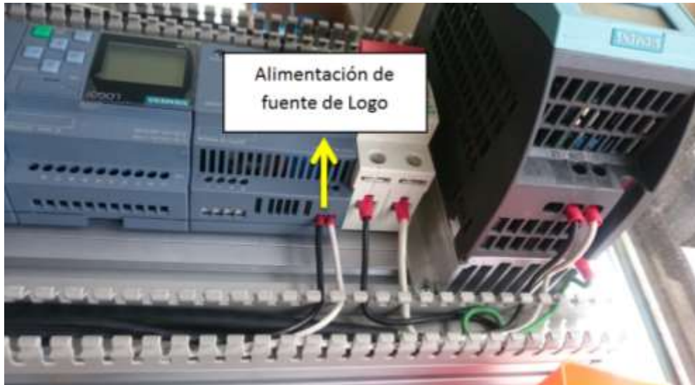
Figura 55. Conexión de alimentación fuente Logo
