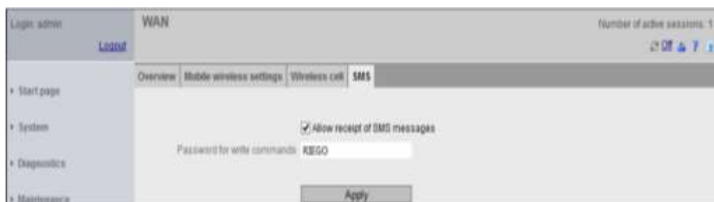
Figura 38. Activación de recepción de SMS para el telecontrol. Por Zabala (2016)
