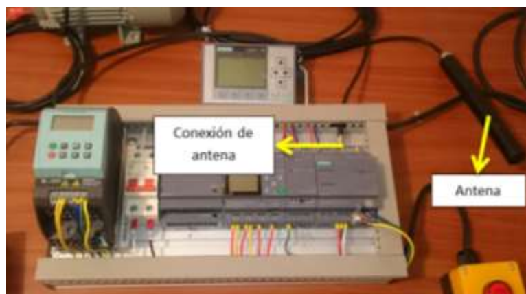
Figura 64. Ensamblaje de la antena
