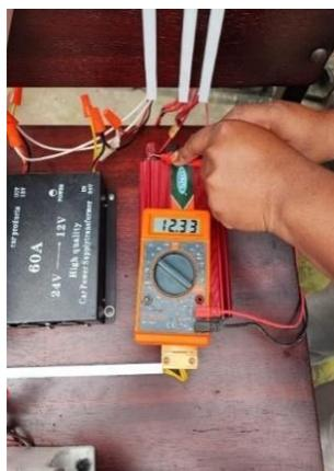
*Nota.* Esta gráfica representa la medición de voltaje del inversor de corriente.
