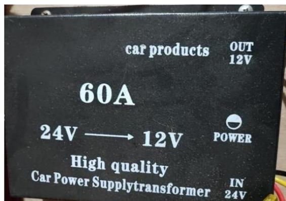
*Nota.* Esta gráfica representa el módulo de inversor de energía. Reproducido de reductor de voltaje de 24v a 12v de 60A, por VISIÓNLED, 2018.
