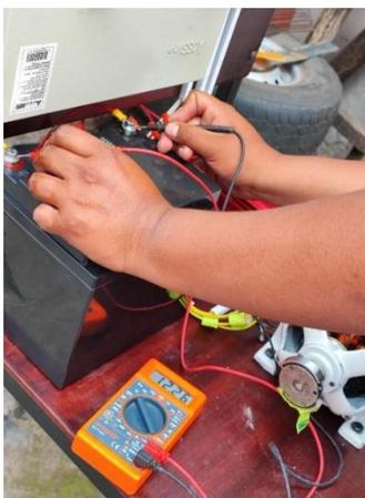
*Nota.* Esta gráfica representa la medición de voltaje de la batería solar en reposo.
