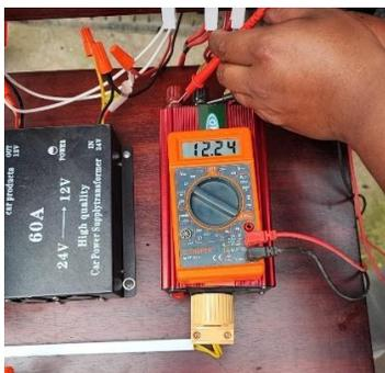
*Nota.* En esta gráfica representa la medición de voltaje del inversor de corriente.
