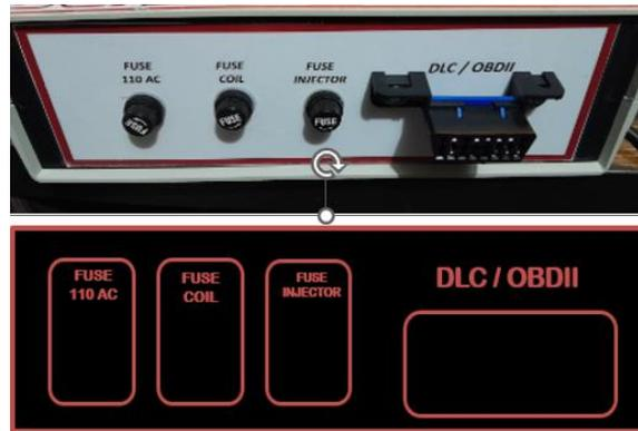
*Nota.* Esta gráfica representa la instalación del conector por el cual vamos a poder conectar el Scanner automotriz.
