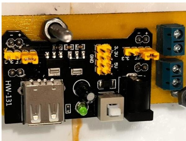
*Nota.* Módulo regulador de voltaje de 5V para proyectos de electrónica, elaboración propia.
