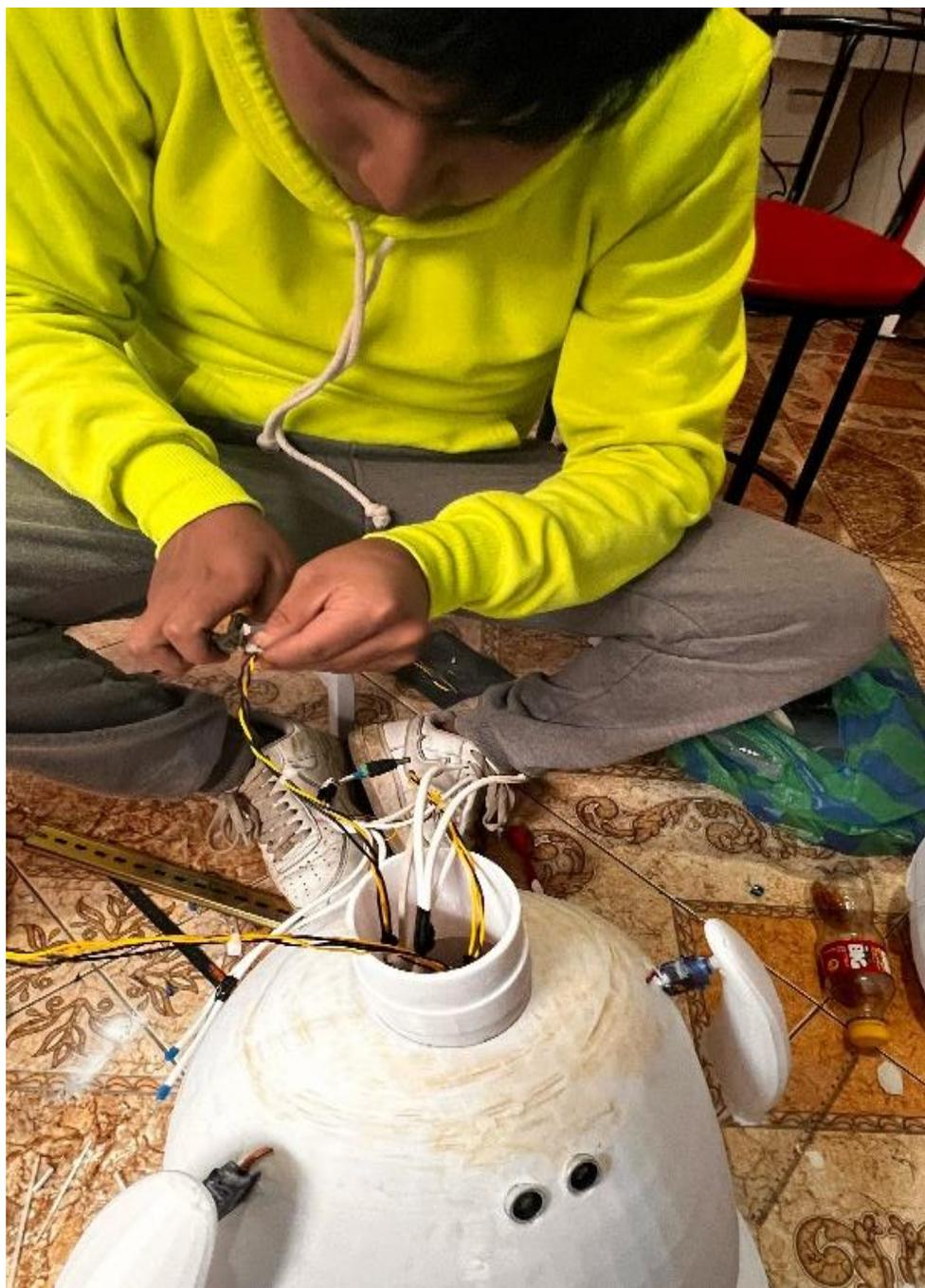
*Nota.* Se instalo terminales para los motores, elaboración propia.
