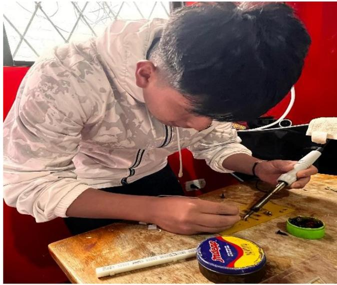
*Nota.* Luego de colocar todos los elementos de acuerdo con el diagrama se procedió a soldar cada pin en la placa de la baquelita, elaboración propia.
