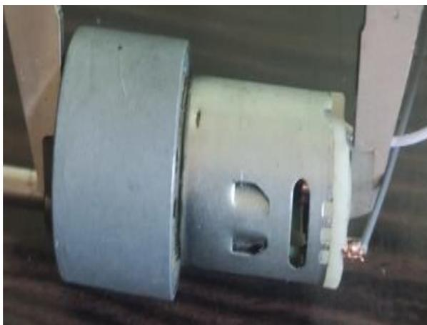
*Nota.* Motor con motorreductor de 12V, tiene torque que un motorreductor de 5V, elaboración propia.
