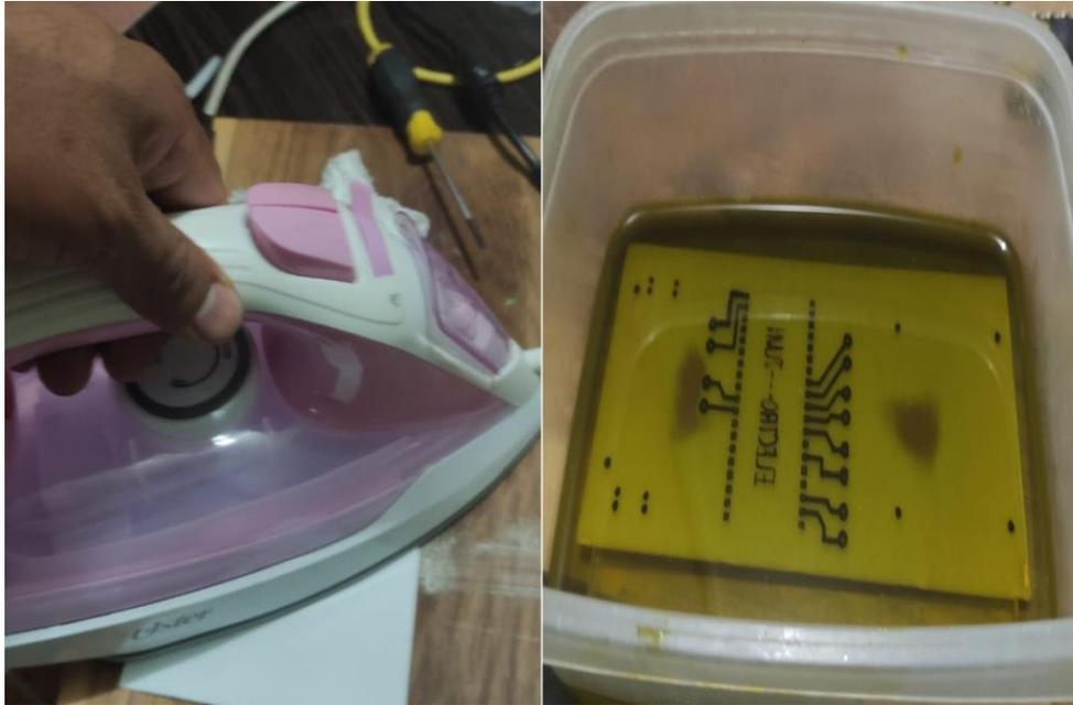
*Nota.* Proceso del planchado en la placa de baquelita para luego colocar en ácido para quitar el exceso del cobre de la placa, elaboración propia.
