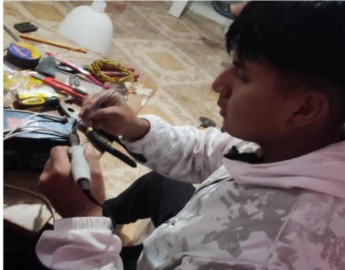
*Nota.* Se soldaron cables en los terminales de la batería de igual manera de asegurar en la base de la estructura con amarraderas plásticas, elaboración propia.
