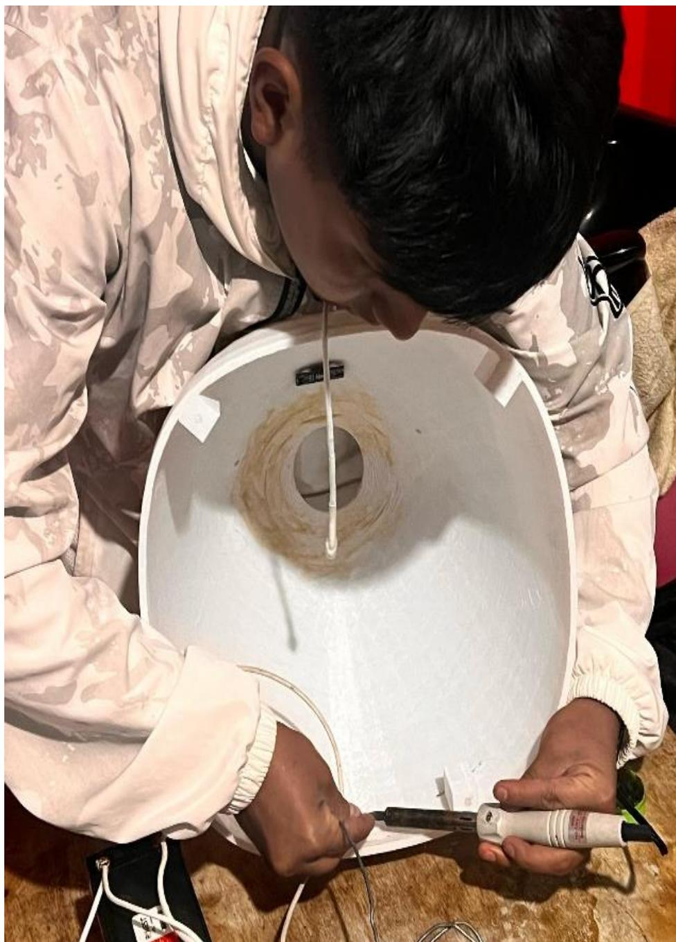
*Nota.* Como se observa se está soldando el interruptor y los terminales para cargar la batería, elaboración propia.
