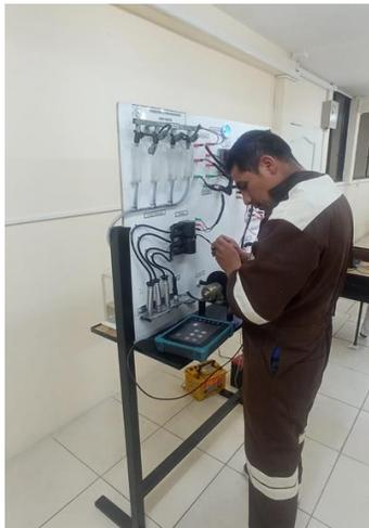
*Nota.* Esta imagen pertenece a la medición de voltajes en la bobina encendido.
