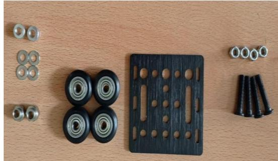
*Nota.* Carrito para perfil de aluminio previo a ser armado y colocado en el sistema.
