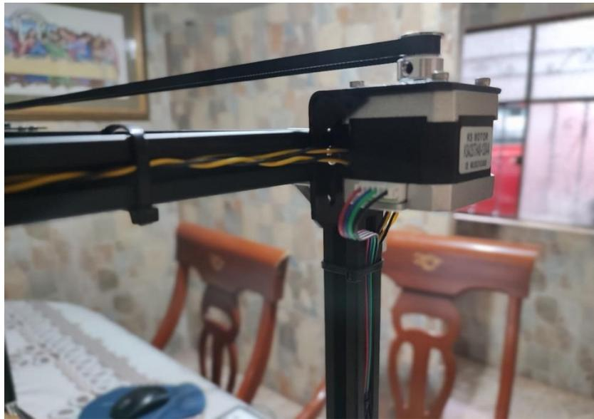
*Nota.* Se puede visualizar la colocación de los cables por dentro de los perfiles, permitiendo así que no se generen daños al momento de colocar libros o manipular la máquina.
