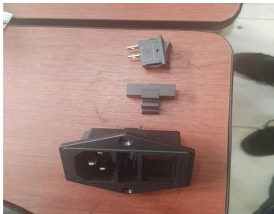
*Nota.* En la siguiente imagen se puede apreciar de que partes está compuesto un switch interruptor con fusible.
