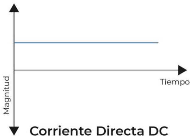
*Nota.* La imagen refleja el sentido que tiene la corriente continua. Reproducido de Corriente continua, por ventiladores.com, 2021 (<https://ventiladores.com/>).
