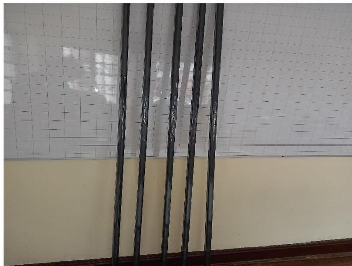
*Nota.* En la siguiente imagen se puede visualizar los perfiles de aluminio V slot de medida 20x20.
