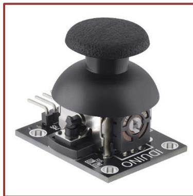
*Nota.* El gráfico se muestra un joystick, el cual hará los movimientos en los ejes X e Y dentro del sistema. Reproducido de Joystick, por Steren, 2022 (<https://www.steren.com.ec/joystick.html>).
