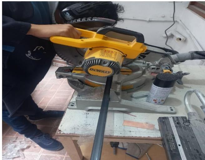
*Nota.* En la siguiente imagen se puede visualizar como se llevaron a cabo el corte de los perfiles de aluminio para el ensamble de la estructura.
