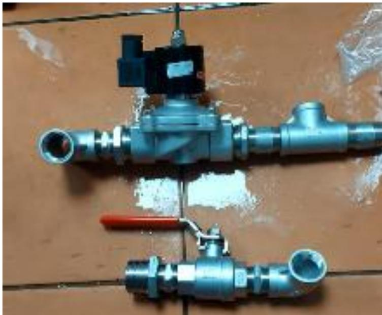
*Nota.* En la imagen se puede observar los accesorios para el circuito de agua como llaves de paso y válvula solenoide.
