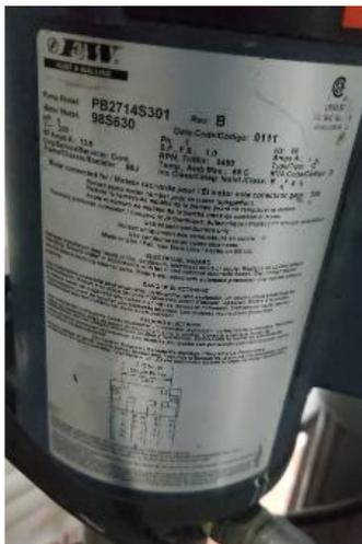
*Nota.* En la imagen se muestran las especificaciones de la bomba centrífuga.
