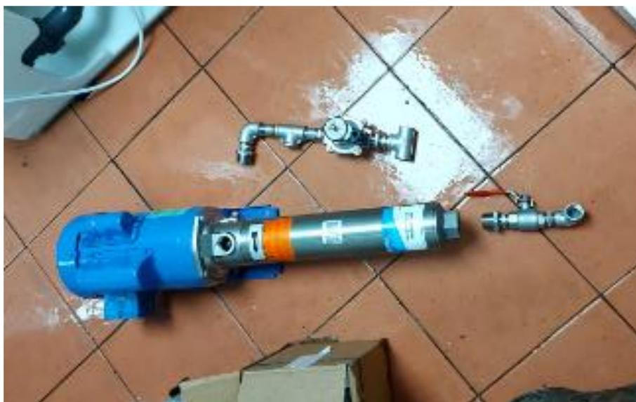
*Nota.* En la imagen se muestran los accesorios para la instalación de la nueva bomba centrífuga.
