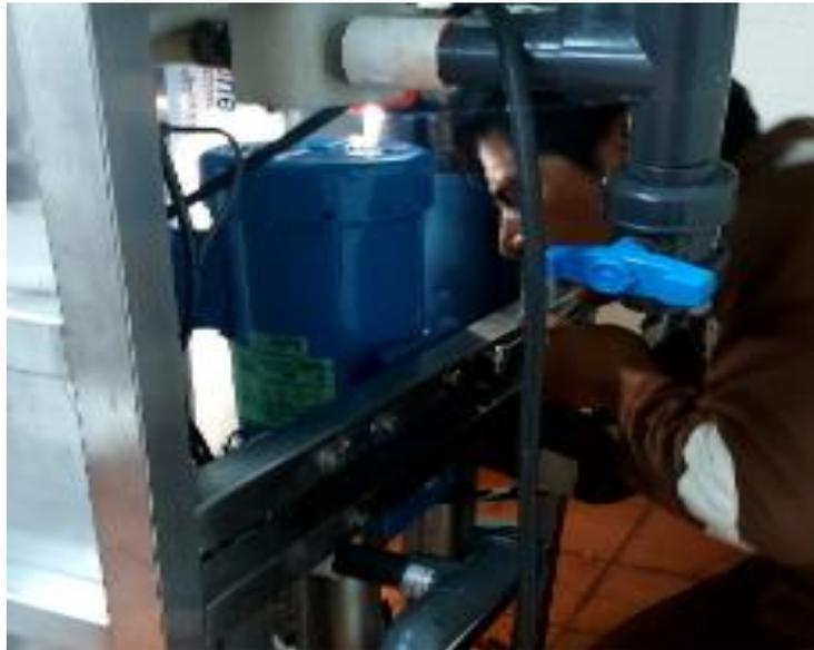
*Nota.* En la imagen se muestra el apriete de los pernos de sujeción en la estructura de la máquina.
