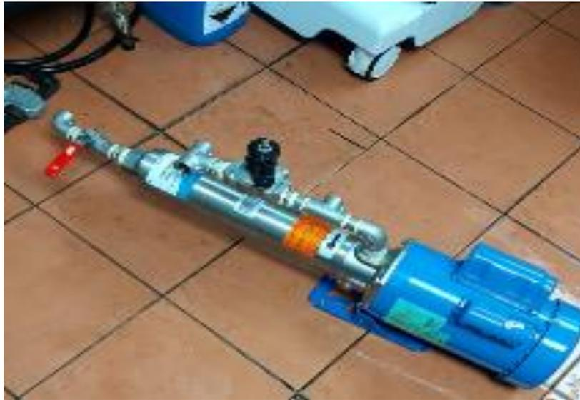
*Nota.* En la imagen se muestra la conexión de los accesorios en la salida a la bomba centrífuga para después instalarla en la máquina de ósmosis inversa.
