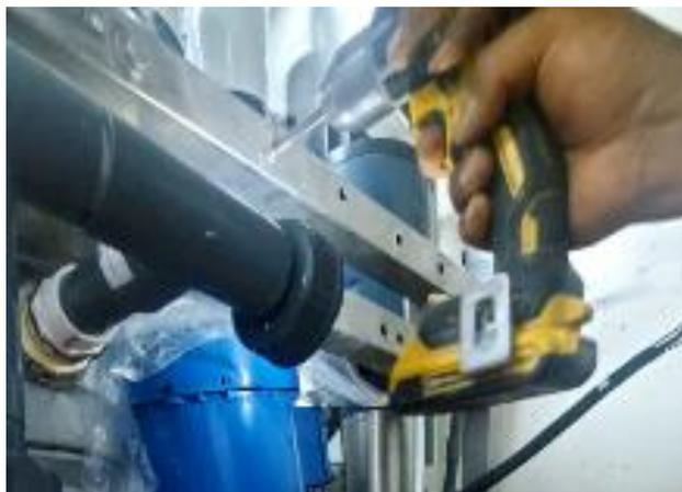
*Nota.* Mecanizado del taladro en la estructura para implementación de la bomba centrífuga.
