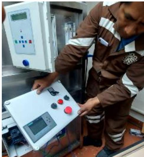
*Nota.* Colocación de la tapa en la caja de protección eléctrica.
