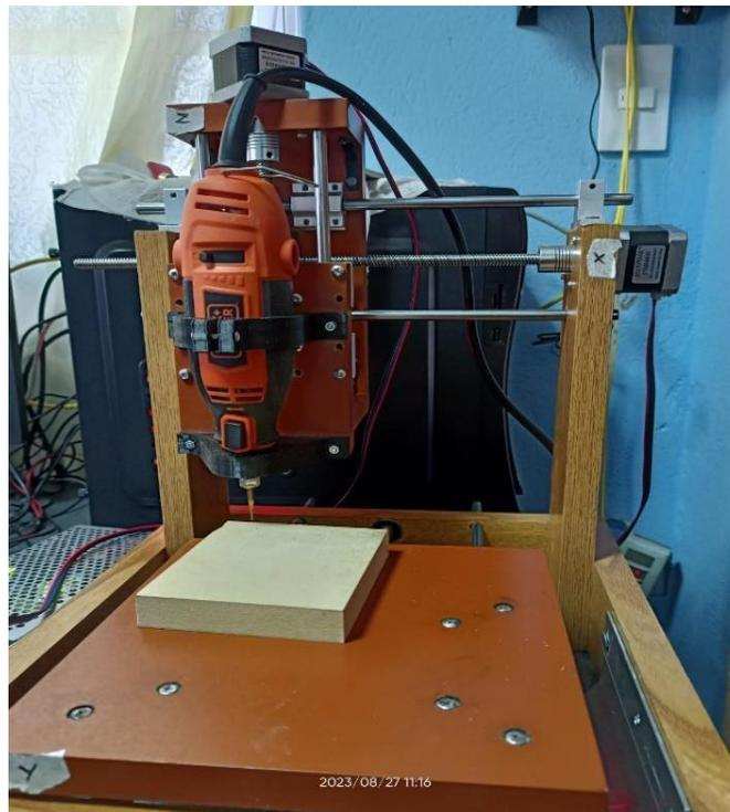
*Nota.* Se instalo todos los elementos para la máquina CNC, elaboración imagen propia.
