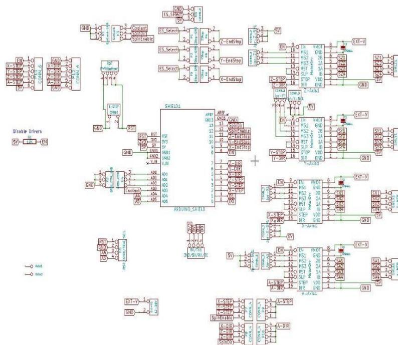
*Nota.* El diagrama se utiliza para ver las conexiones de la CNC Shield, como se conecta cada motor la imagen fue extraída del sitio web Dinastía Tecnológica.
