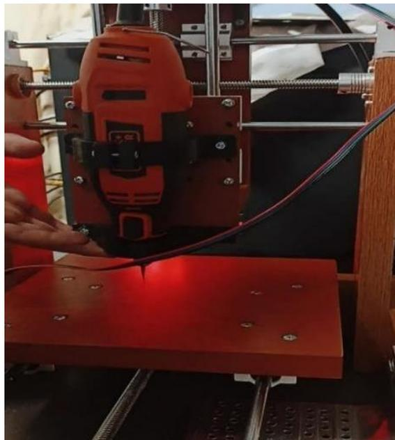
*Nota* El peso que tiene el eje Z y una mala alineación que se tiene en los rodamientos lineales se dio a una quema de un fusible en la CNC Shield.
