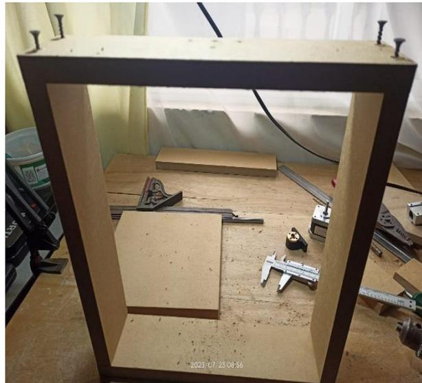
*Nota.* Se realizo perforaciones para colocar los Tornillos madera 40mm que sostendrán los ejes Y, X.
