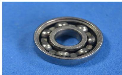
Nota. Se usa para soportar el tornillo de desplazamiento del eje, extraída Nuevas metodologías no invasivas de diagnóstico de defectos incipientes en rodamientos de bola.
