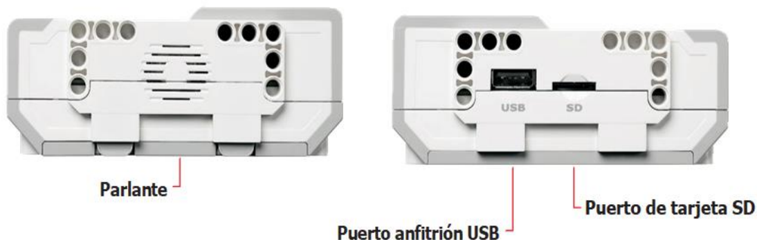
Imagen No. 27 Parlante y Puertos de Bloque Inteligente Ev3 Elaborado por: Bryan Roberto Pila Acosta Fuente: Propia
