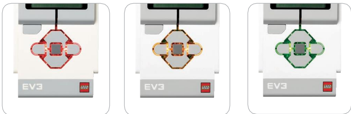
Imagen No. 25 Luz de estado del Bloque Inteligente Ev3 rojo, naranja, verde. Elaborado por: Bryan Roberto Pila Acosta Fuente: Datos de la investigación.
