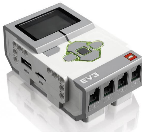
Imagen No. 23 Bloque Inteligente Ev3 Elaborado por: Bryan Roberto Pila Acosta Fuente: Propia
