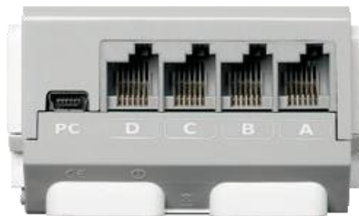
Imagen No. 39 Conexión de Motores Elaborado por: Bryan Roberto Pila Acosta Fuente: Propia.
