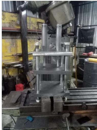
Imagen No. 14 Estructura de la prensa Elaborado por: Luis David Pozo Constante Fuente: Datos de la investigación
