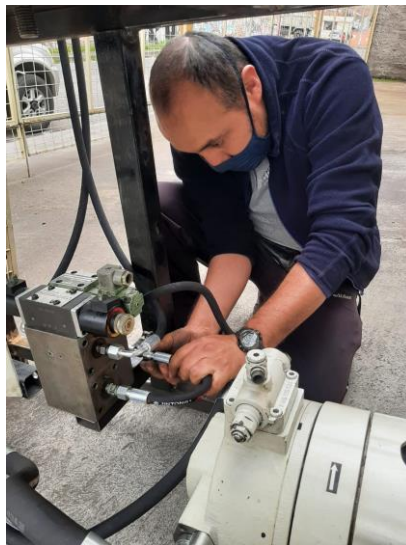
Imagen No. 21 Conexión de mangueras oleohidráulicas Elaborado por: Luis David Pozo Constante Fuente: Datos de la investigación
