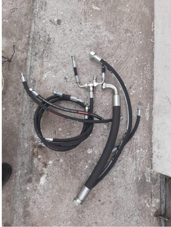
Imagen No. 53 Mangueras Tipo R2 Elaborado por: Luis David Pozo Constante Fuente: Datos de la investigación
