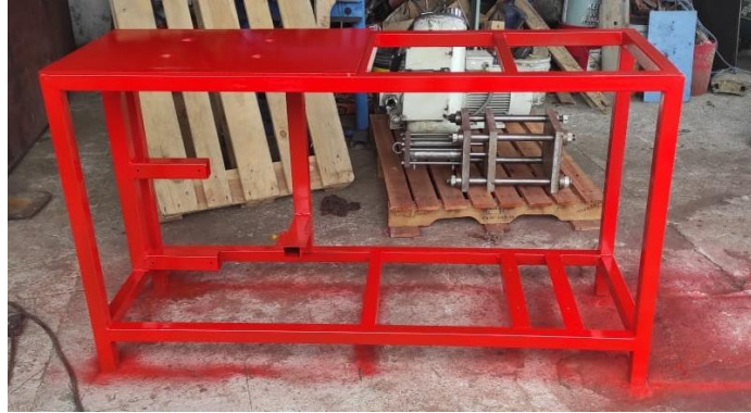
Imagen No. 19 Estructura de soporte de la prensa pintada
