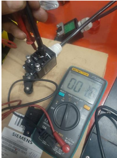
Imagen No. 43 Comprobación de finales de Carrera Elaborado por: Luis David Pozo Constante Fuente: Datos de la investigación
