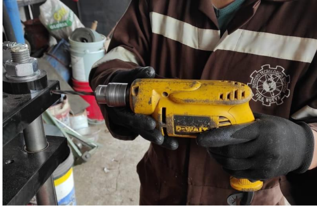
Imagen No. 36 Perforación de placa móvil Elaborado por: Luis David Pozo Constante Fuente: Datos de la investigación
