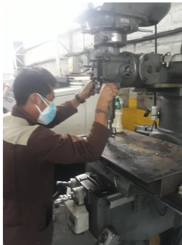
Imagen No. 18 Perforación en la plancha de fijación de la prensa
