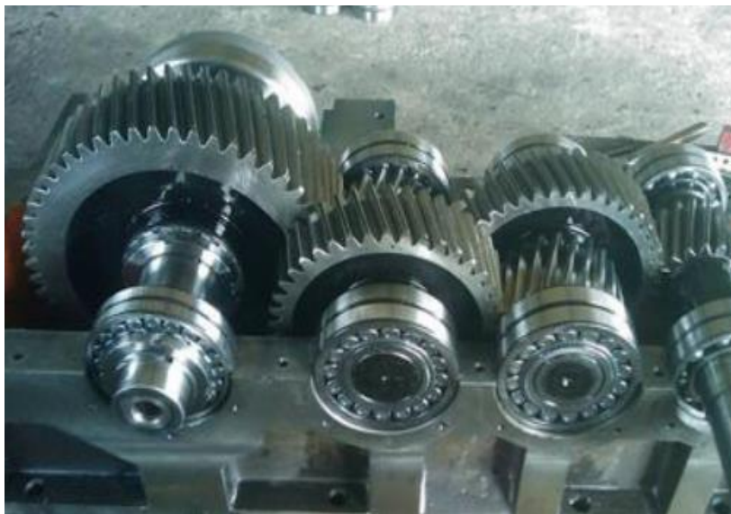
Imagen No. 5 Caja reductora con engranajes Elaborado por: García Larrea Esteban (2016). Fuente: Datos de la investigación
