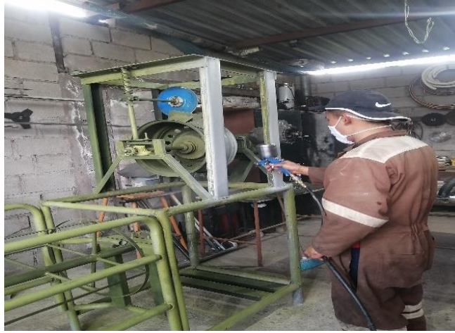
Imagen No. 40 Fondeado primera capa Elaborado por: Bautista Alvarez Nixon Flavio Fuente: Datos de la investigación
