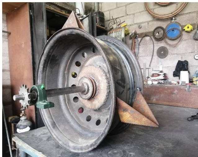
Imagen No. 34 Acople de las piezas que transportan el cacao Elaborado por: Bautista Alvarez Nixon Flavio Fuente: Datos de la investigación
