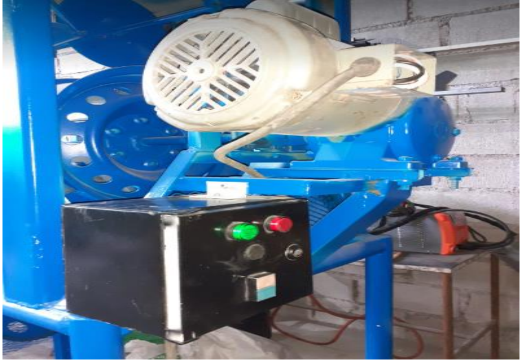
Imagen No. 47 Accionamiento de encendido y apagado Elaborado por: Bautista Alvarez Nixon Flavio Fuente: Datos de la investigación
