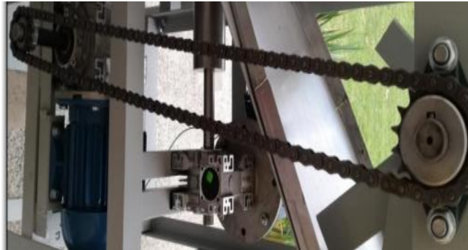
Imagen No. 15 Transmisión por cadena Elaborado por: Mayacela Augusto (2017) Fuente: Datos de la investigación
