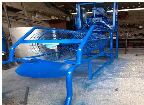
Imagen No. 41 Pintado final de la máquina Elaborado por: Bautista Alvarez Nixon Flavio Fuente: Datos de la investigación
