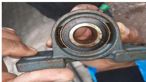
Imagen No. 32 Chumacera Elaborado por: Bautista Alvarez Nixon Flavio Fuente: Datos de la investigación
