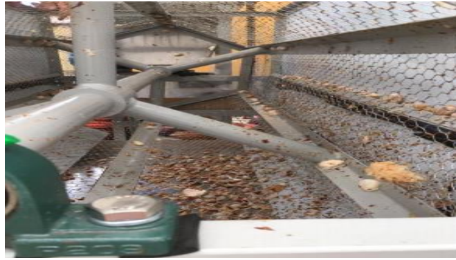
Imagen No. 16 Despulpadora de cacao Elaborado por: Mayacela Augusto (2017) Fuente: Datos de la investigación
