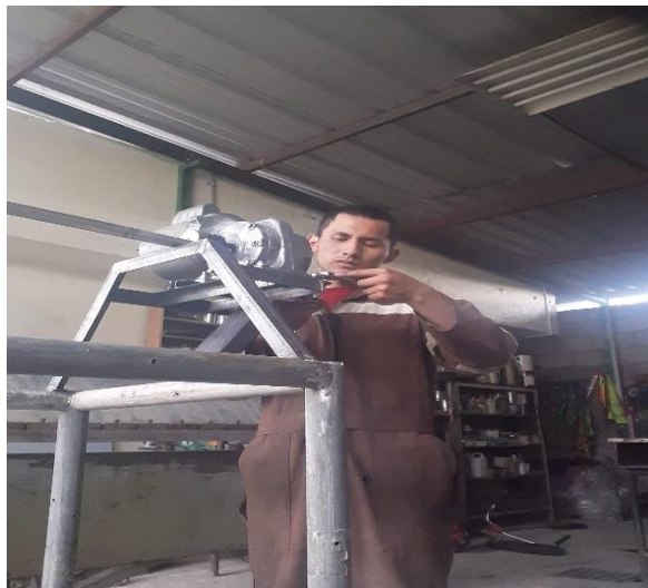
Imagen No. 30 Instalación el motor Elaborado por: Bautista Alvarez Nixon Flavio Fuente: Datos de la investigación
