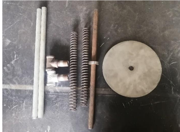
Imagen No. 35 Piezas de la cuchilla Elaborado por: Bautista Alvarez Nixon Flavio Fuente: Datos de la investigación
