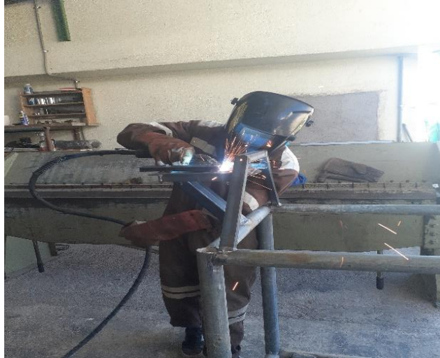
Imagen No. 29 Construcción del soporte del motor Elaborado por: Bautista Alvarez Nixon Flavio Fuente: Datos de la investigación
