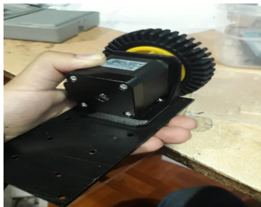
Figura 37. Colocación de los motores en base inferior. Fuente: Elaboración propia. (2020).
