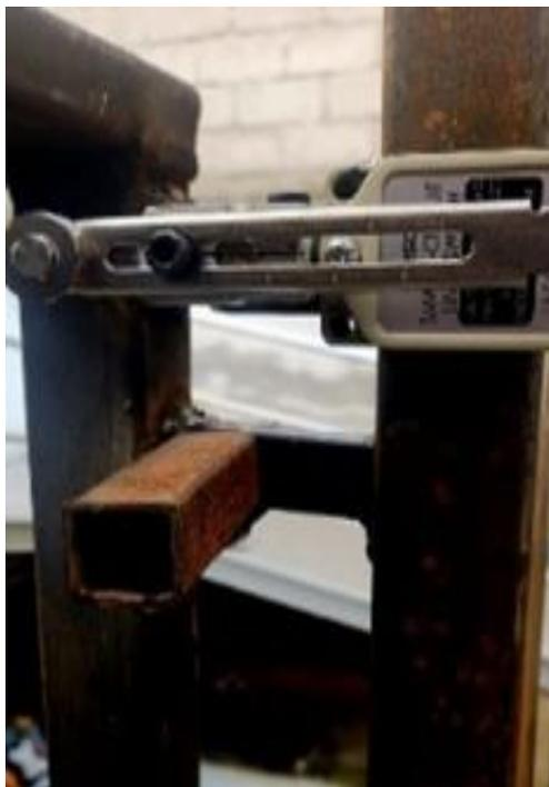
*Nota.* En esta imagen se puede visualizar que se incluyó un fin de carrera el cual es fundamental ya que su función principal es detectar la posición final de un objeto o un sistema en movimiento y detenerlo, también se colocó el tubo cuadrado de 2.5mm, encargado del accionar del fin de carrera.
