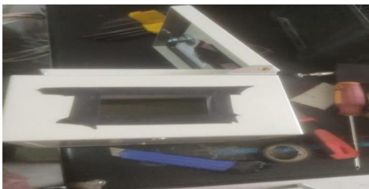
*Nota.* Los cortes en el gabinete metálico se protegen con taipe para que no existe ningún corte.
