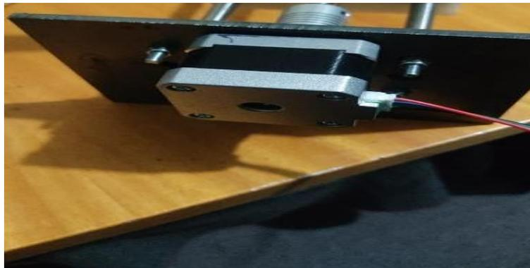
*Nota.* Instalación del motor a pasos en la placa en acero negro.
