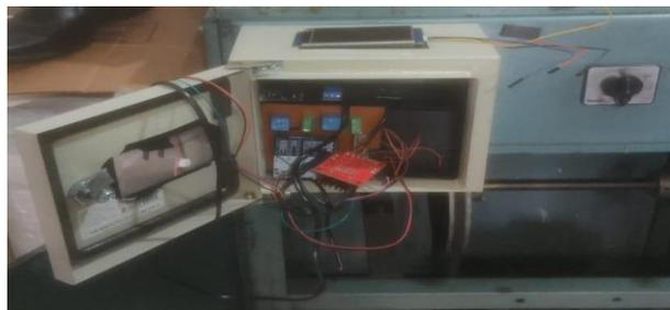
*Nota.* Las tarjetas electrónicas se disponen dentro del gabinete en donde ningún elemento o persona pueda interferir con el funcionamiento.
