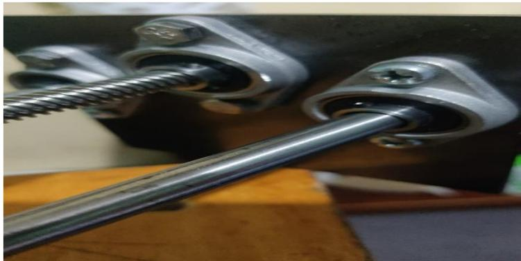
*Nota.* Se instala los ejes acerados y el tornillo sin fin en las placas mediante chumaceras y rodamientos para un mejor sostén de los ejes.
