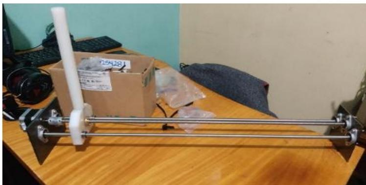
*Nota.* Instalación del eje para el alambre de cobre esmaltado con su dirección hacia arriba.
