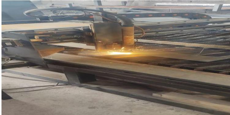
*Nota.* El diseño de las placas se realizó dentro de la misma interfaz de la maquina CNC.
