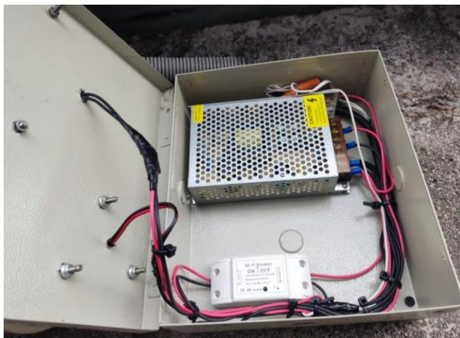
**Nota.** Conexiones y reacondicionamiento de la caja de protección y el interruptor inteligente.
