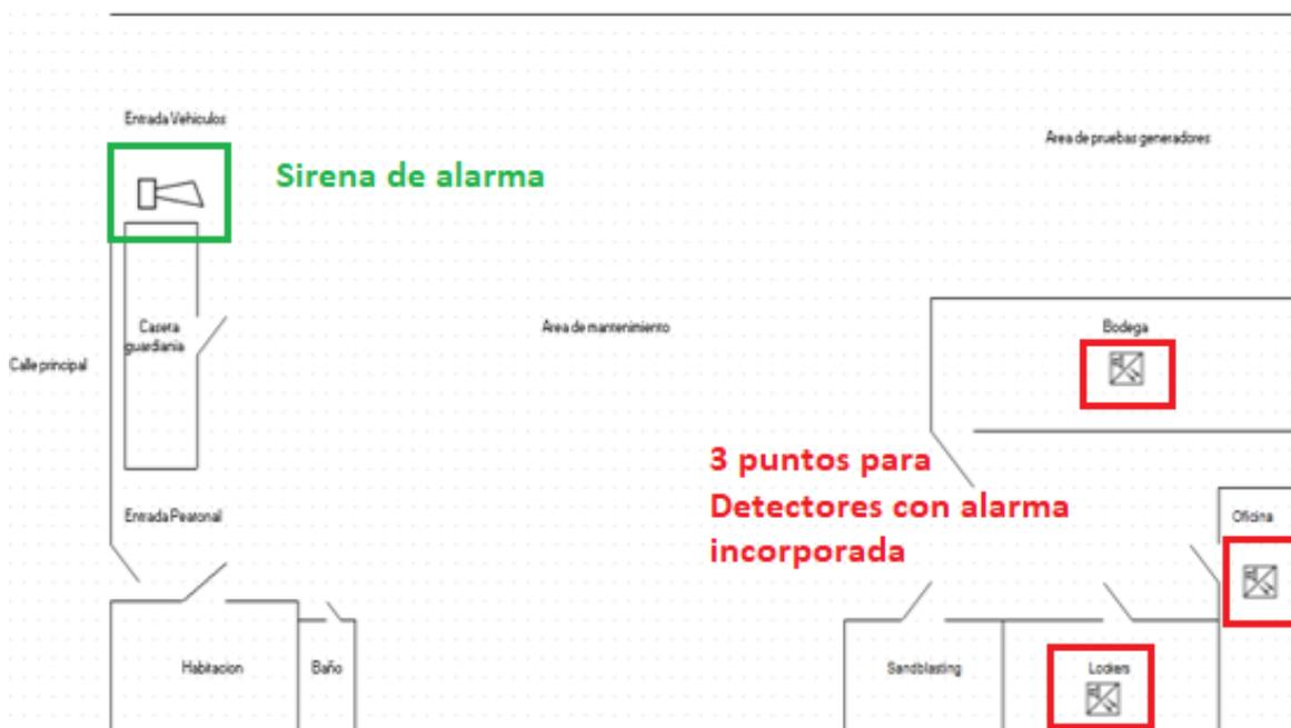
**Nota.** Puntos de conexión a los detectores humo y muestra de la sirena en el diagrama
