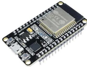
*Nota.* Representación grafica del microcontrolador ESP32. Tomado de Polaridad. Todo lo que necesitas saber sobre el ESP32: un microcontrolador versátil - Polaridad.es.
