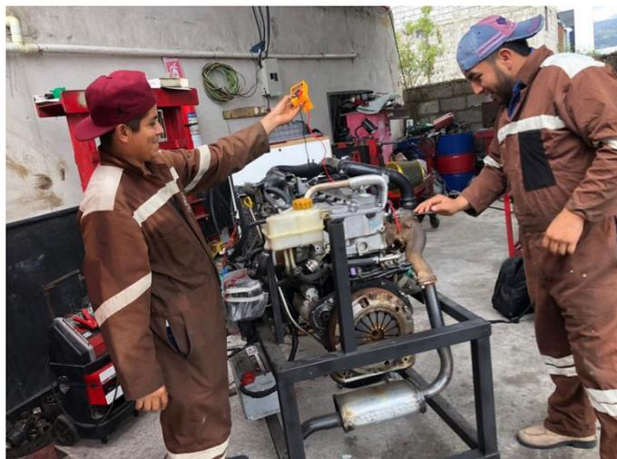
*Nota.* Esta gráfica representa la inspección inicial del funcionamiento del simulador de fallas para actuadores del sistema CRDI del vehículo Chevrolet Dmax del año 2019.
