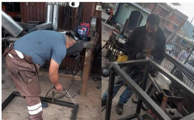
*Nota.* Esta gráfica representa la unión de las piezas de la estructura metálica mediante soldadura para formar la estructura del motor de la Chevrolet DMAX 2019.
