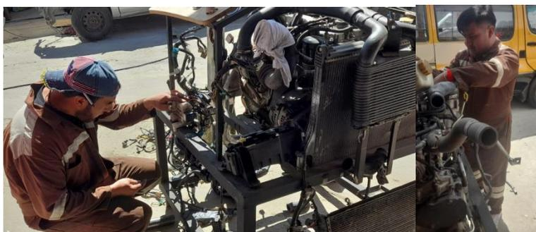
*Nota.* Esta gráfica representa la inspección de las conexiones eléctricas del motor de la Chevrolet DMAX 2019 a Diésel.
