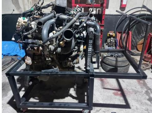
*Nota.* Esta gráfica representa la aplicación de la capa de pintura en la estructura metálica y el montaje del motor de la Chevrolet DMAX 2019 a Diésel.
