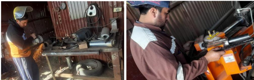
*Nota.* Esta gráfica representa el corte de los perfiles para formar la estructura del motor de la Chevrolet DMAX 2019.
