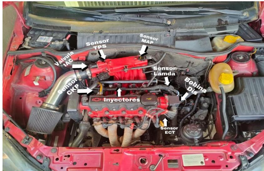
*Nota.* Ubicación de los sensores y actuadores de la gestión electrónica del motor
