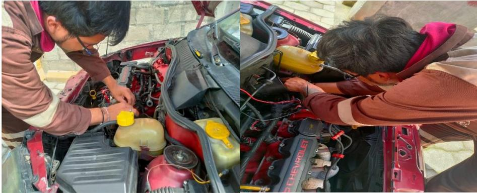
**Desmontaje del Arnes de Cables**
