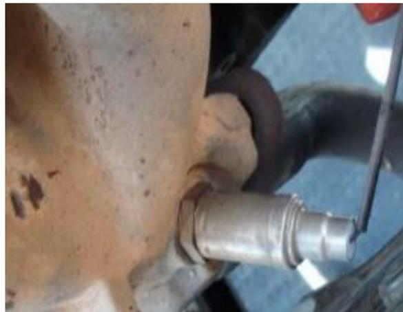
*Nota.* Sensor de Oxígeno con un Solo Pin de Conexión
