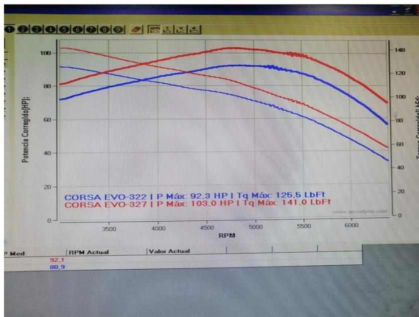
Nota. ■ Potencia= 91 Hp a 5,300 RPM a 2,850 msnm ■ Torque = 14,19 Kg/m= 139.16 Nm a 5,300 RPM a 2,850 msnm
