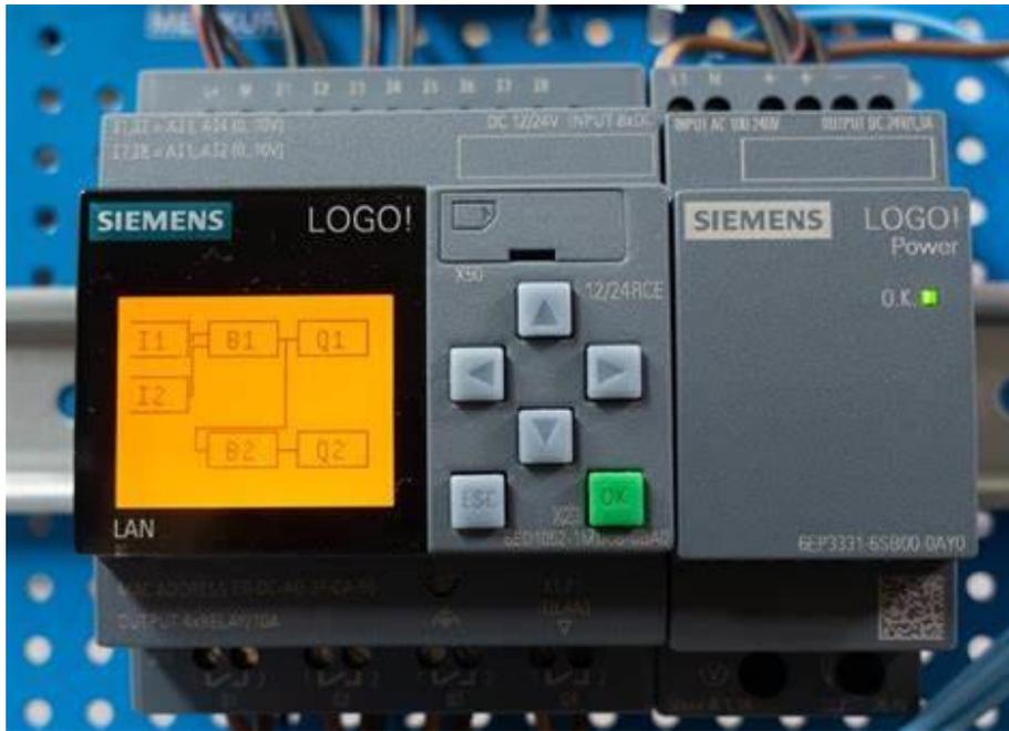
*Nota.* La figura muestra la programación en un PLC LOGO de la marca Siemens.
