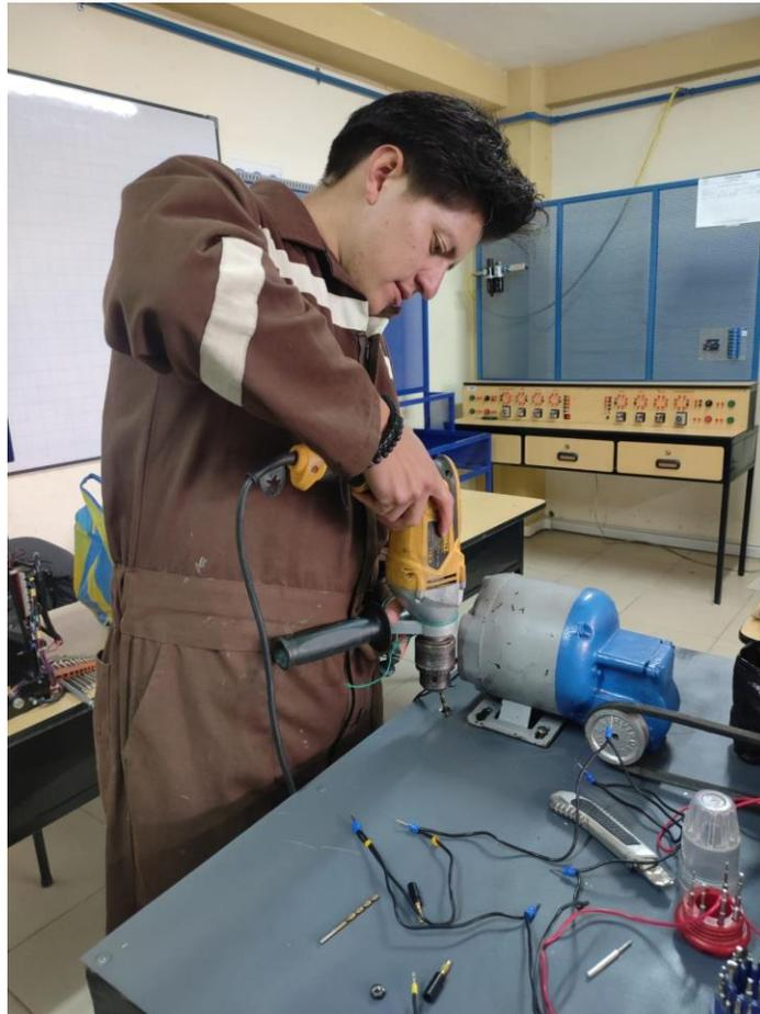
*Nota.* La figura muestra la realización de orificios para la conexión de un motor con ayuda de un taladro y una broca de 1/2.
