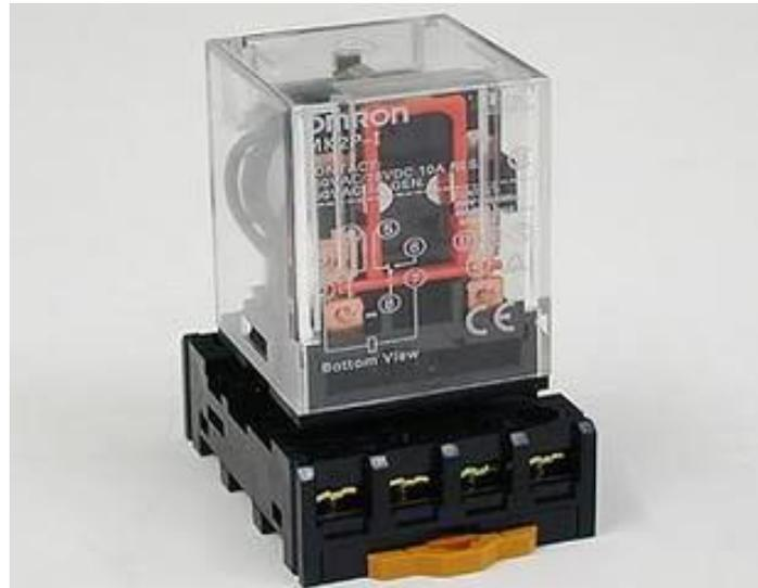
*Nota.* La figura muestra un relé electromagnético de 250VAC/28VCC, además se puede observar los contactos abiertos, cerrados y bobinas con su debida numeración y simbología, esto para evitar daños al momento de conectar este componente.
