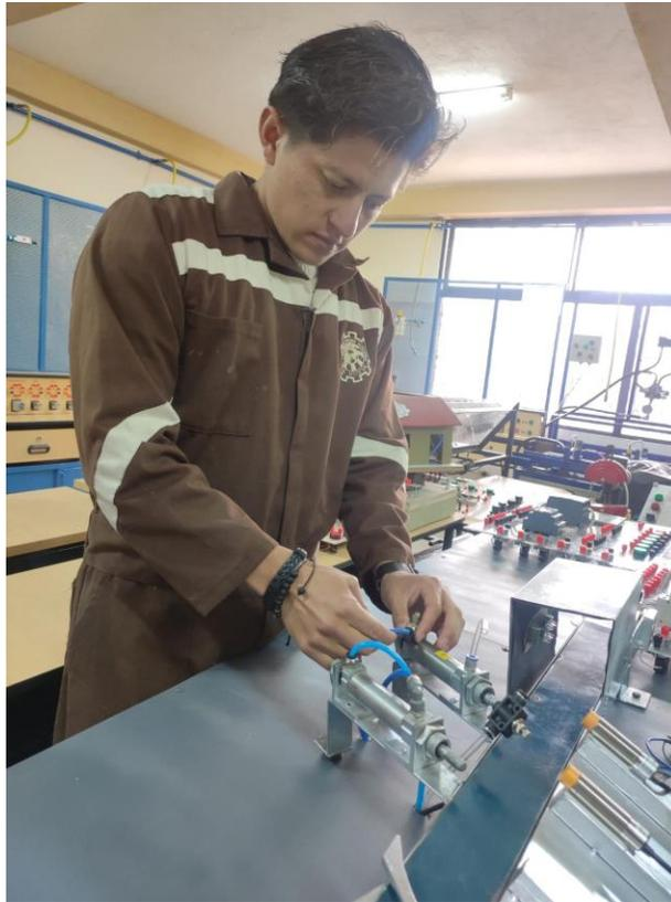
*Nota.* La figura muestra la conexión de mangueras neumáticas
