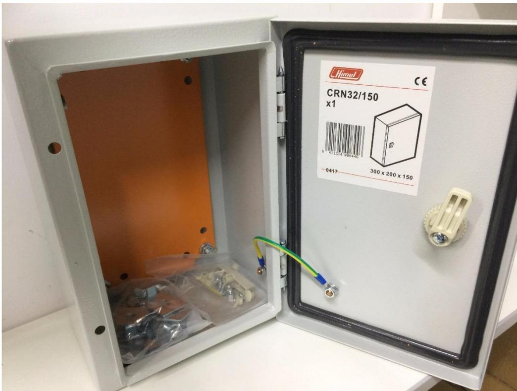
*Nota.* En la figura se observa los orificios realizados para el montaje de pulsadores y luces piloto.
