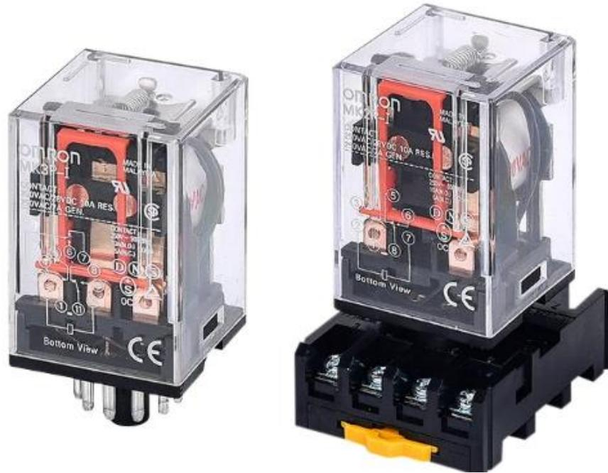
*Nota. Elaboración propia. Cambio de Relé de 8 pines con bobina de 12V a un relé de 24V por sobrecalentamiento.*
