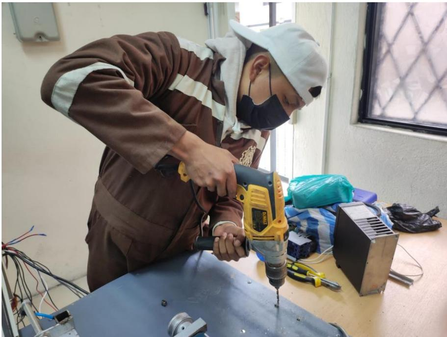
*Nota.* En la figura se puede observar la unión del tol y la estructura mediante autoperforantes con ayuda de un taladro.
