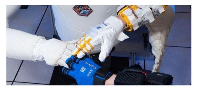
*Nota*. Este modelo cuenta con sensores de presión y tendones sintéticos, lo que permite al usuario sostener objetos con menor esfuerzo y mayor comodidad. Adaptado por muyinteresante.com, por la NASA y General Motors, 2018, Fuente. (https://www.muyinteresante.com.mx/422839/guante-robotico/).
