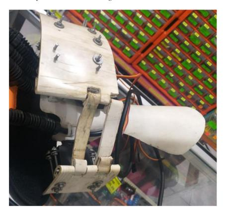
*Nota*. Se realizó el moldeado con calor de la base del guante y se limo las los bordes de la pieza modelada.
