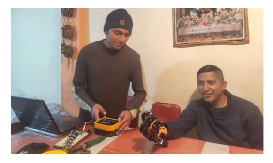
*Nota*. En esta prueba se verifico el funcionamiento del guante neumático con sus diferentes configuraciones del módulo de accionamiento.
