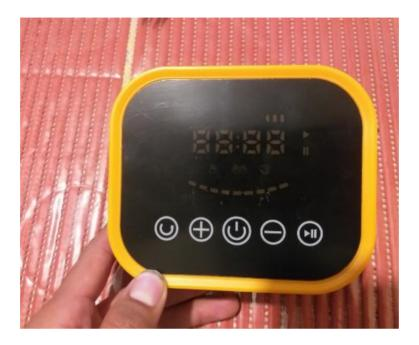
*Nota*. Se muestra la parte frontal del panel del módulo que acciona al guante neumático de fácil uso y compacto.
