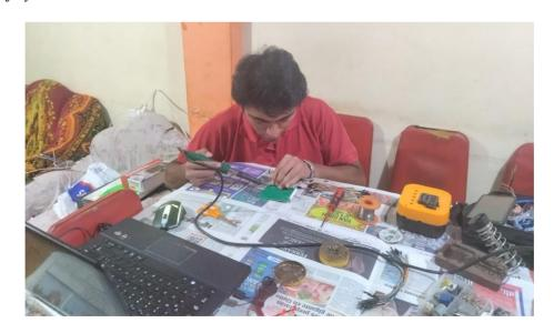
*Nota*. Modificaciones de la placa el desarrollo de las pruebas de funcionamiento con la tarjeta electrónica ESP32.
