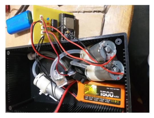
*Nota*. Instalación de los componentes en esta sección de manera que permitan que el nuevo módulo controle el guante neumático.
