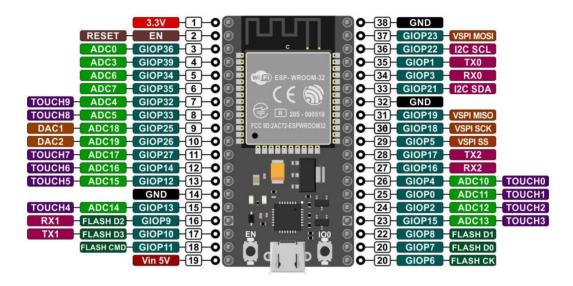
Nota. Este modelo representa una actualización ideal del conocido ESP8266. El ESP32 ofrece una cantidad mucho mayor de GPIO, múltiples entradas analógicas, dos salidas analógicas y una variedad de periféricos adicionales. Adaptado por Victor Asanza, por Microelectronics, 2023, Fuente. (https://vasanza.blogspot.com/2021/07/especificaciones-del-modulo-esp32.html).
