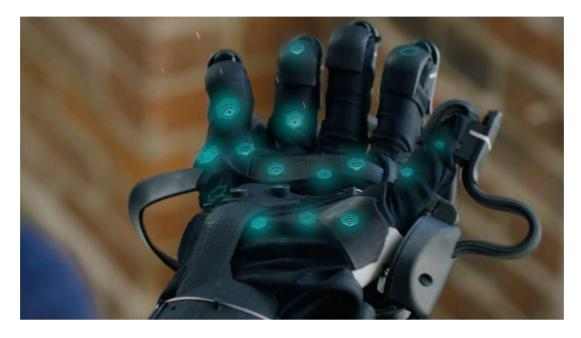
Nota. Este modelo se basa en la micro-neumática para implementar un sistema de retroalimentación de fuerza para los dedos. Adaptado por VR-NERDS, por HaptX, 2017, Fuente. (https://www.vrnerds.de/haptx-glove-micro-pneumatic-fuer-finger-force-feedback/) vrnerds.de.
