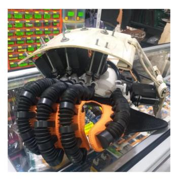
*Nota*. Se ajustó la distribución de los servos en las llaves del guante, así como el apoyo requerido para su correcto movimiento del exoesqueleto.
