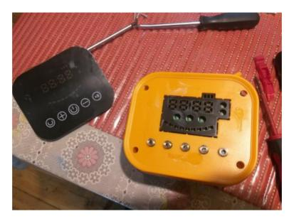
*Nota*. Se presento un poco de dificultad al momento de la apertura ya que no se encontraba los orificios de desmontaje del panel frontal del guante neumático.
