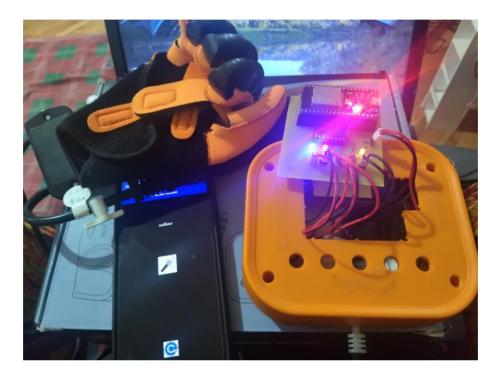
Nota. Se reviso el funcionamiento del guante neumático con la tarjeta ESP32 configurada.
