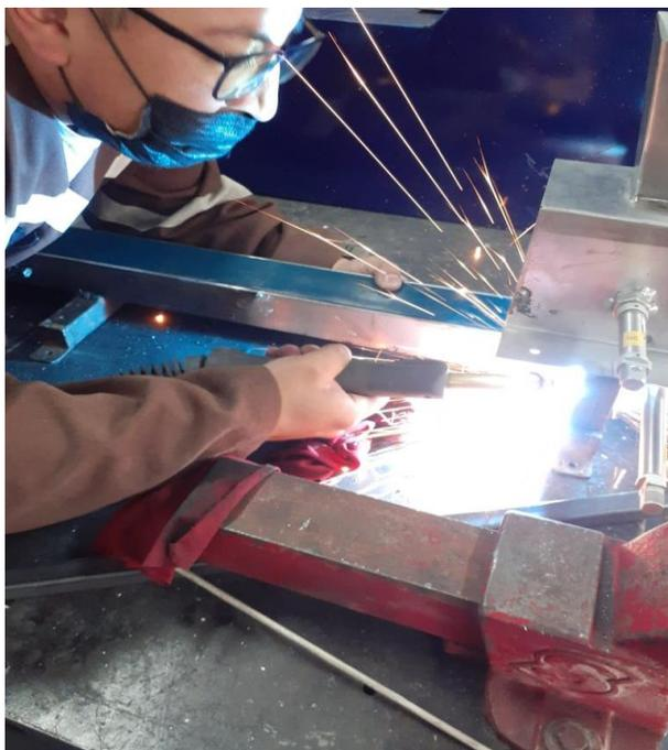
*Nota.* Dentro de la imagen se aprecia el proceso de unión de materiales con el uso de la soldadura MIG.
