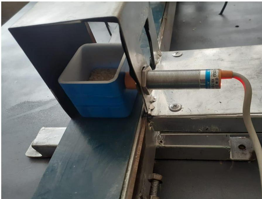
*Nota.* Se colocaron los sensores dentro de las posiciones preliminares para poner a prueba su funcionamiento.
