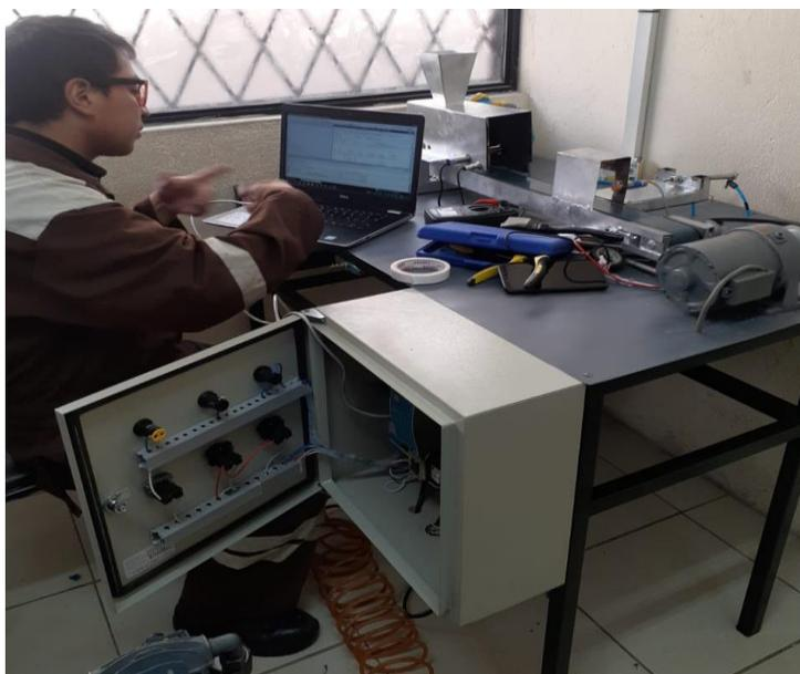
*Nota.* Dentro de la imagen se puede observar el proceso de subida de la programación desde TIA portal al PLC S7 1200.
