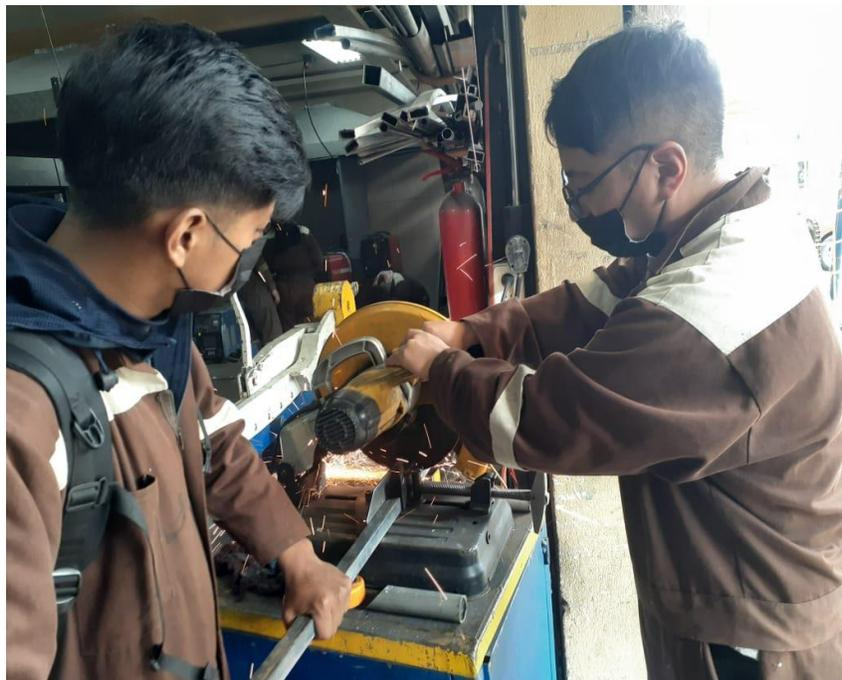
*Nota.* En la imagen se aprecia el corte de acero estructural cuadrado con la utilización de la cortadora de metal.
