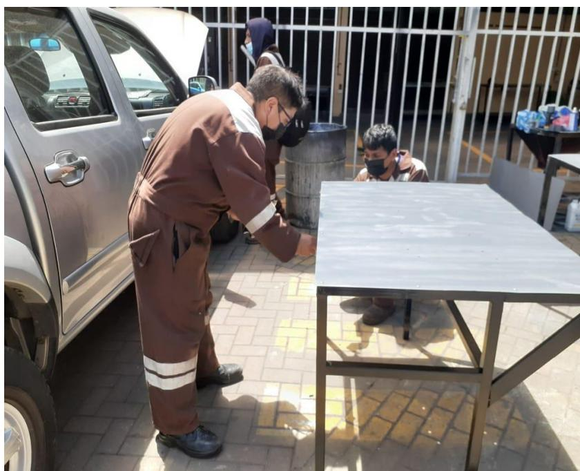
*Nota.* En esta figura se aprecia el proceso de matizado de la estructura de soporte del módulo de dosificación con la ampliación de pintura en spray.
