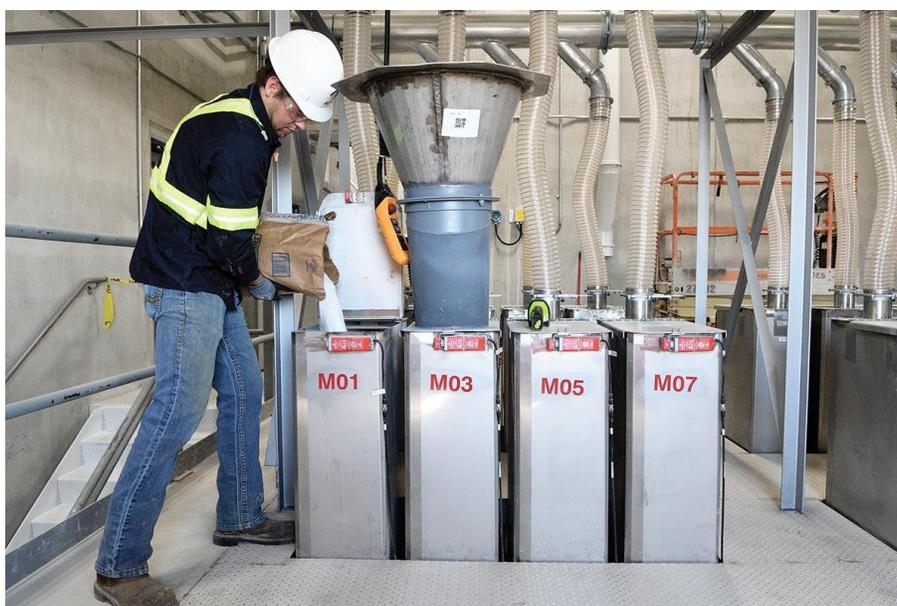
*Nota.* La imagen se aprecia un sistema de dosificación de alimento para mascotas. Tomado de Protección de ingredientes para elaboración de alimento, por ADM, 2020.
