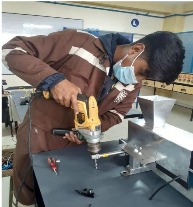
*Nota.* Dentro de la imagen se observa el proceso de perforación para los orificios de los soportes de la banda transportadora y los elementos de dosificación.
