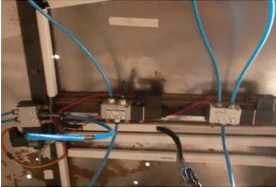
*Nota.* Las electroválvulas colocadas en la estructura de dosificación, fueron energizadas para comprobar su funcionamiento.
