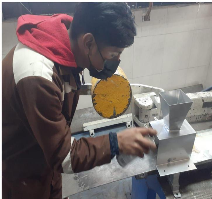
*Nota.* A continuación, se observa el proceso de matizado para la tolva y los demás elementos de la estructura de dosificación.
