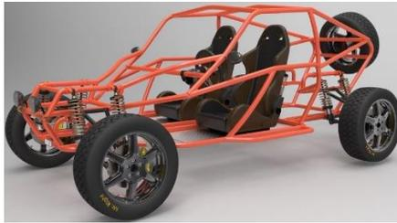
*Nota:* Identificación de un tipo tubular. Chasis Tubular.
