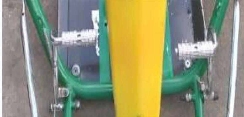
En la imagen podemos observar los diferentes pedales del vehículo tipo go – kart, estos nos ayudan a poder mover, detener el mismo ya que se encuentran conectados mediante cables hacia diferentes partes del motor y de la estructura del go – kart. Gracias a estos pedales podemos evitar cualquier tipo de accidente en la pista o carretera.
