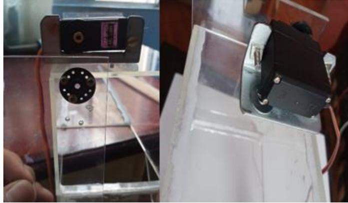
*Nota.* En la figura se muestra la compuerta acoplada al servomotor.
