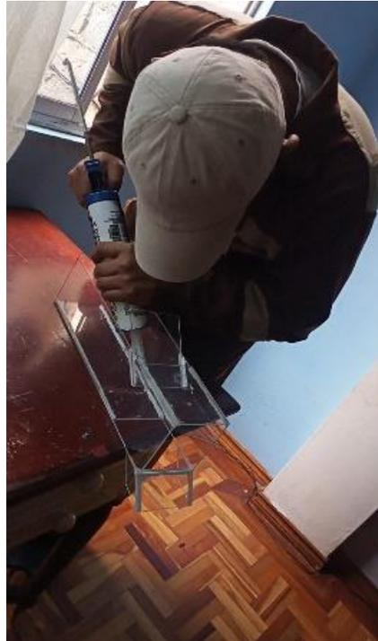
*Nota.* La figura muestra el ensamblaje de las partes del túnel dosificador.
