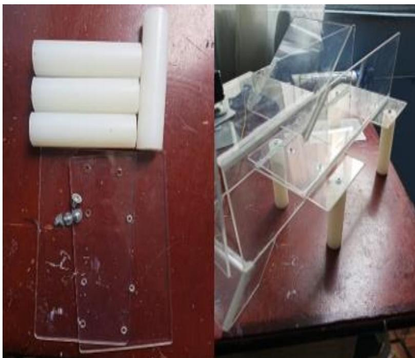
*Nota.* En la figura se muestra las partes de la base para el túnel dosificador.
