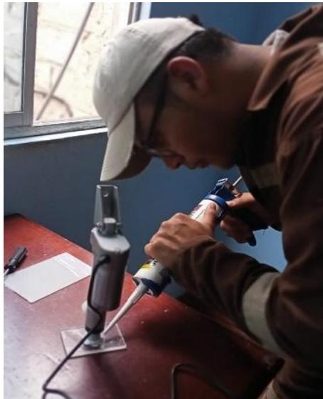
*Nota.* En la figura se muestra la unión de la placa de acrílico con el pistón.
