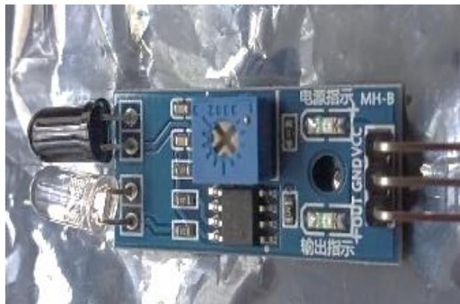
*Nota.* La imagen muestra el sensor infrarrojo usado para el proyecto.
