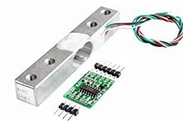
*Nota.* Esta figura muestra el módulo HX 771 y la celda de carga de 1Kg que se utilizó para el proyecto.
