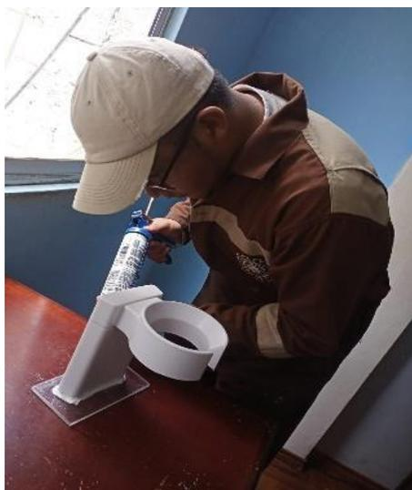
*Nota.* En la figura se muestra el ensamblaje de la base para la tolva.
