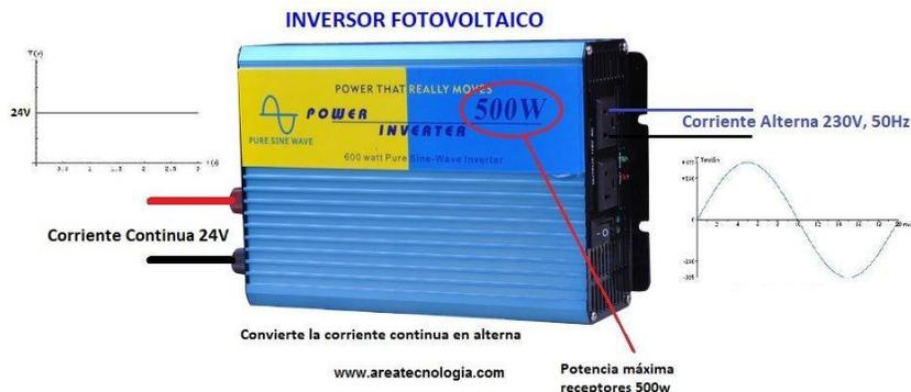
Nota. Inversor este componente de la instalación fotovoltaica que se encarga de convertir la corriente continua a corriente alterna (Areatecnologia, 2022)
