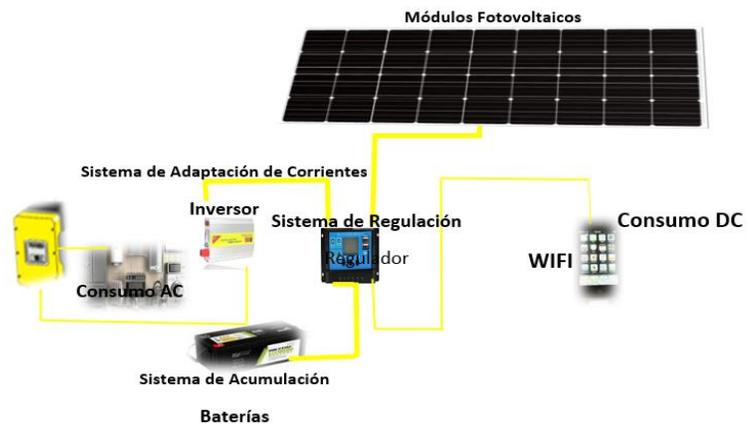
Nota. Diagrama para la conexión eléctrico de un panel fotovoltaico.
