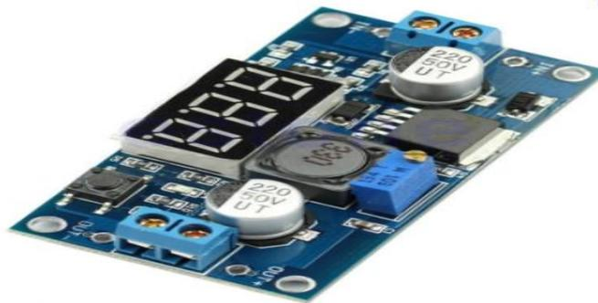
Nota. Convertidor de voltaje que te permite regular el voltaje partir de una fuente de alimentación (Electronilab, 2021)
