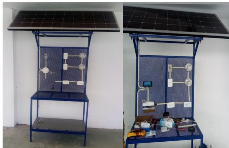
Nota. Instalaciones y conexiones eléctricas de modulo didáctico de un panel solar fotovoltaico.
