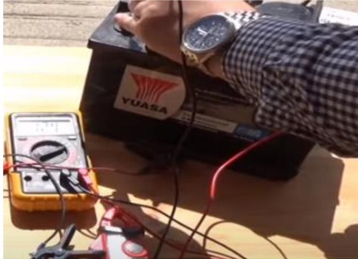
Nota: Medición de voltaje de la batería solar
