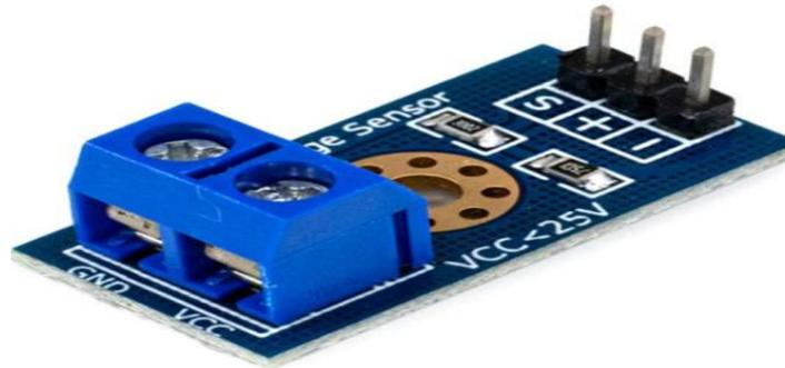
Nota. Pequeño módulo de tensión que puede medir voltajes (Unit Electronics, 2020)
