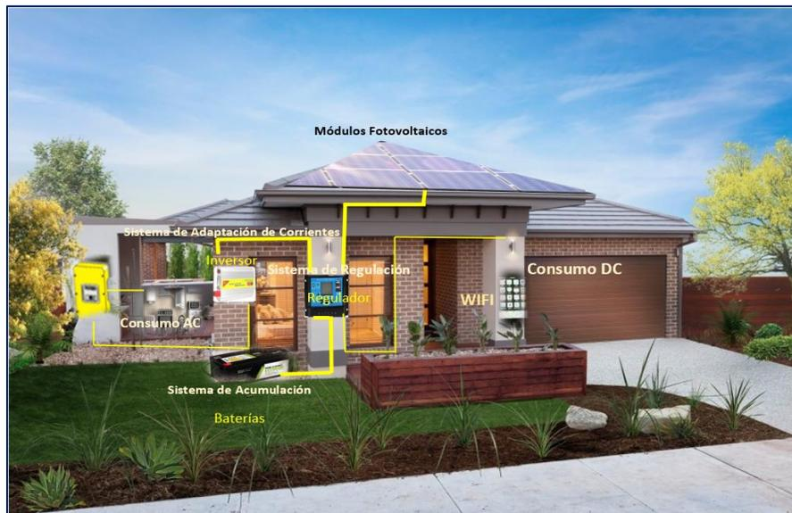
Nota: Diagrama de sistema fotovoltaico mediante la radiación solar.
