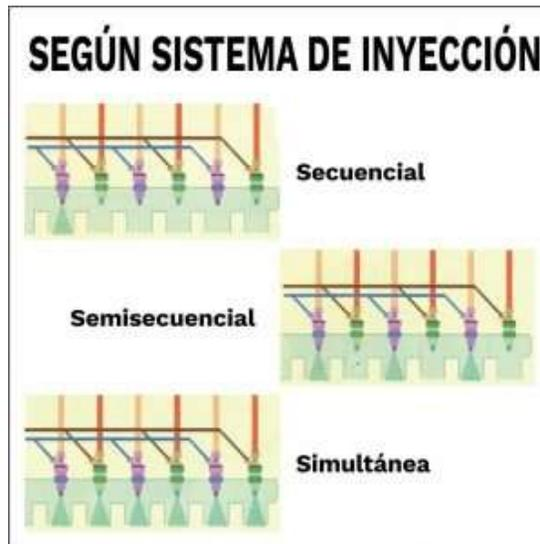
*Nota.* Clasificación por tipo de Inyección. Por (S.P.M , 2018).
