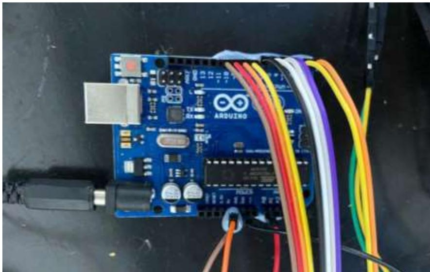
*Nota.* En el Arduino se realiza la programación de los parámetros de funcionamiento del motor.
