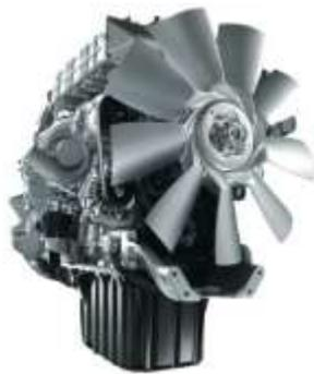
*Nota.* Este ventilador toma su movimiento del extremo delantero del cigüeñal y mueve también la bomba de Este ventilador. Por (AUTOYTECNICA, 2018).
