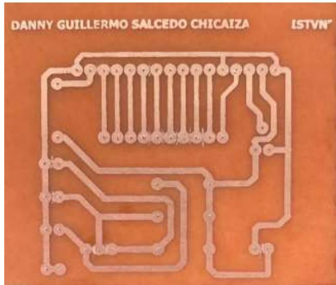
*Nota.* Esta placa representa el diseño impreso de las pistas de conexión entre los diferentes elementos del banco de pruebas.
