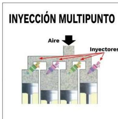
*Nota.* Este sistema utiliza un inyector para cada cilindro sea en inyección directa o indirecta. Por (S.P.M , 2018).
