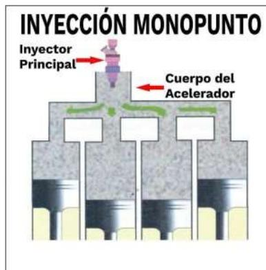
*Nota.* Utilizada en motores de bajo cilindraje, con un solo inyector para todos los cilindros. Por S.P.M, 2018.
