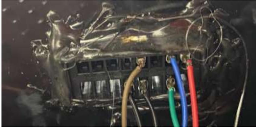
*Nota.* Es un conector de diagnóstico que nos sirve para revisar el funcionamiento de la computadora automotriz por medio de un escáner.
