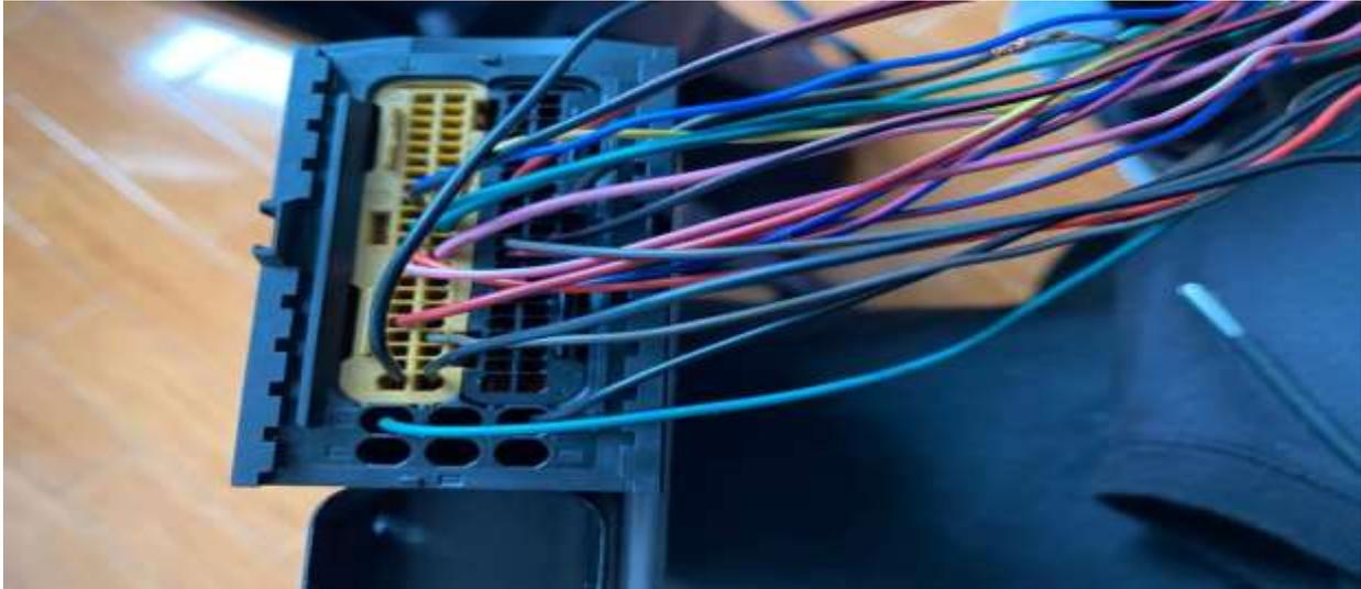
*Nota.* Este conector ayuda a realizar las conexiones de los pines de la computadora automotriz.
