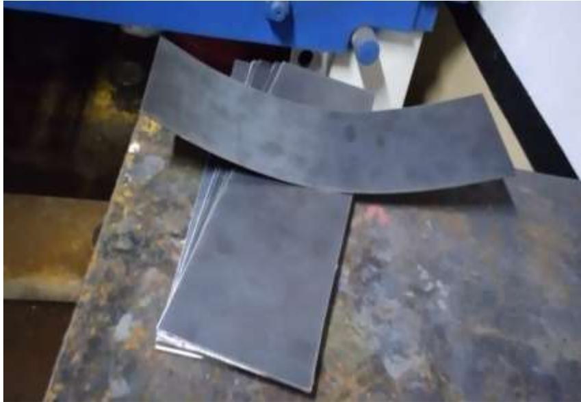
*Nota.* En la siguiente figura se muestra los alabes que fueron cortados con el plasma a una medida específica. Elaboración propia.
