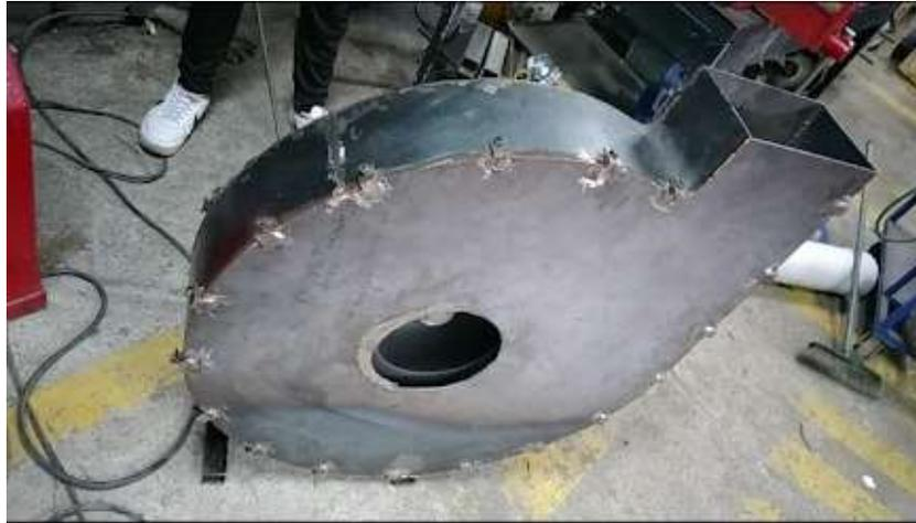
*Nota.* Este armado se realiza mediante soldadura proceso MIG ensamblando así la voluta.
