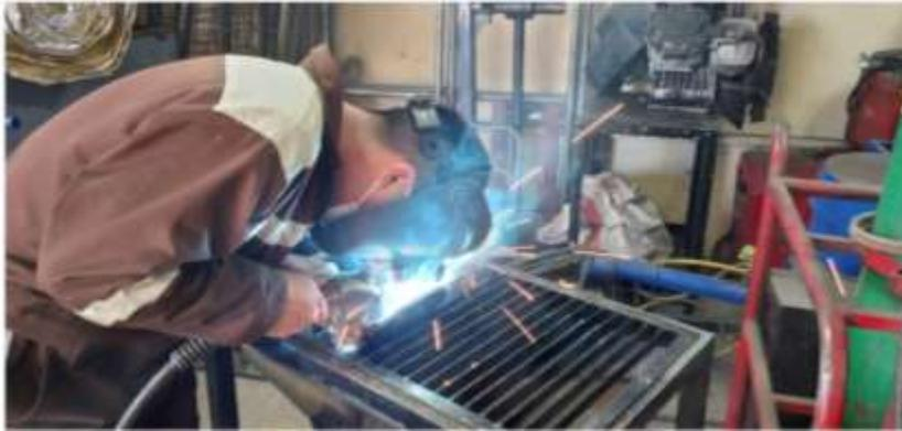
*Nota.* Se muestra la soldadura por partes para evitar que se deforme el material por el calentamiento excesivo.
