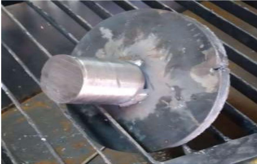
*Nota.* Se muestra el procedimiento de soldadura aplicado en la fabricación de la manzana.
