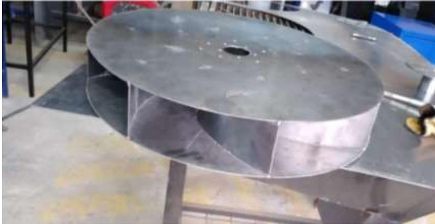
*Nota.* En la figura se muestra cómo se realizó el ensamble mediante soldadura de puntos ciegos la cual ayudara a estar unida y equilibrar el peso para todos los lados. Elaboración propia.
