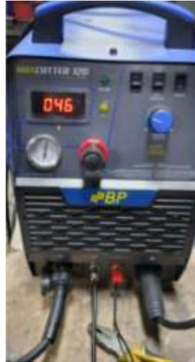
*Nota.* Esta figura representa la máquina plasma utilizada para el proceso de corte de la chapa metálica de dos milímetros y donde se muestra el amperaje al cual se realizaron el corte. Elaboración propia.
