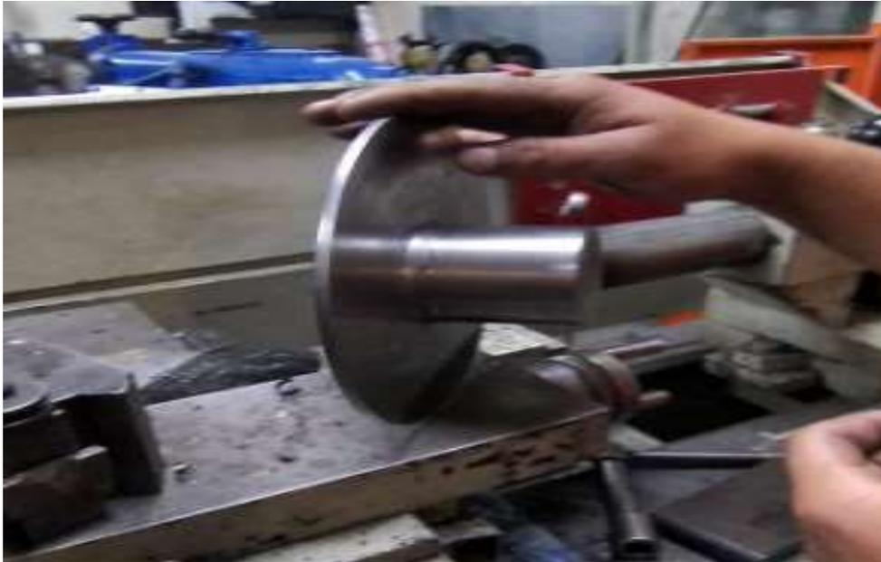
*Nota.* En la figura se muestra cómo se realiza el torneado para la obtención de la medida de los planos. Elaboración propia.
