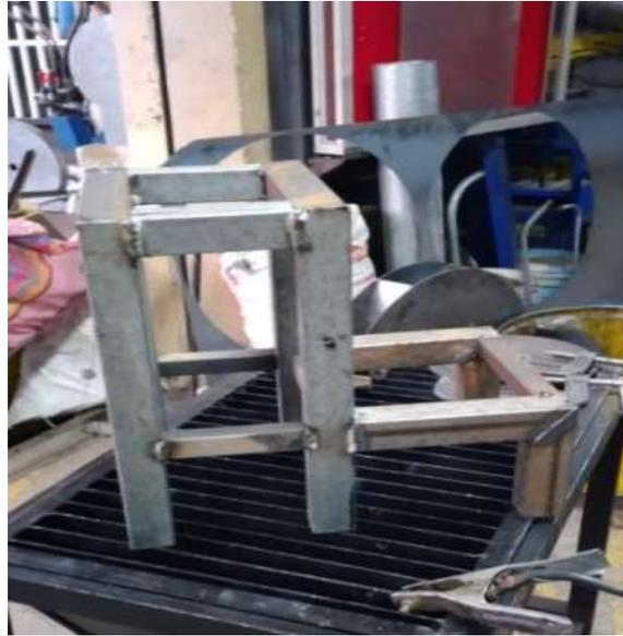
*Nota.* En la siguiente figura se muestra la estructura la cual servirá como soporte y mesa para el motor, poleas, chumaceras las cuales sostendrán el eje de transmisión de movimiento del blower centrifugo. Elaboración propia.
