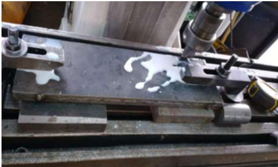
*Nota.* En la figura se muestra como los alabes fueron rectificadas para la obtención de una sola medida para todas. Elaboración propia.
