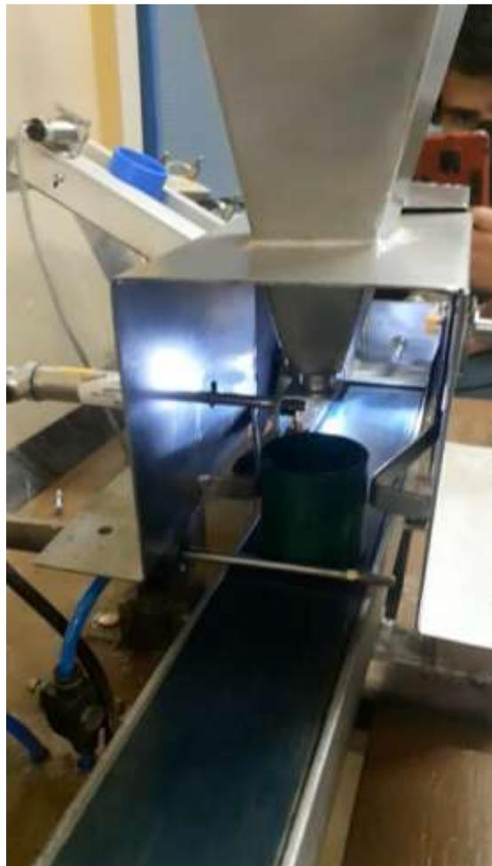
*Nota.* Prueba de funcionamiento de la dosificación temporizada desde la programación.
