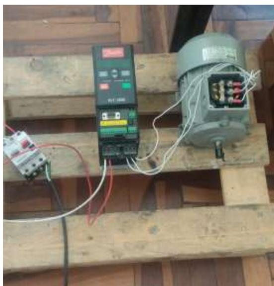
*Nota.* Prueba de funcionamiento del variador de frecuencia.
