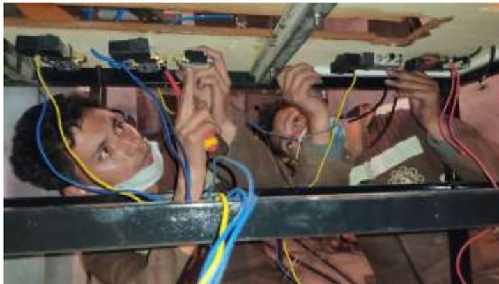
*Nota.* Prueba de funcionamiento de la distribución de aire para las electroválvulas.
