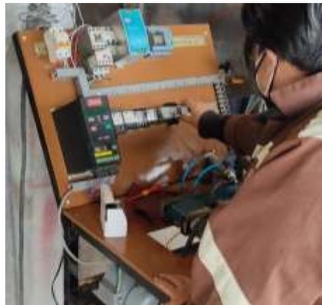
*Nota.* Prueba de funcionamiento del voltaje de cada componente.
