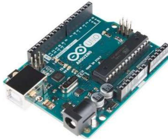
*Nota.* El Arduino es una placa que contiene entradas y salidas analógicas y digitales. Tomado de (ARDUINO, 2017).
