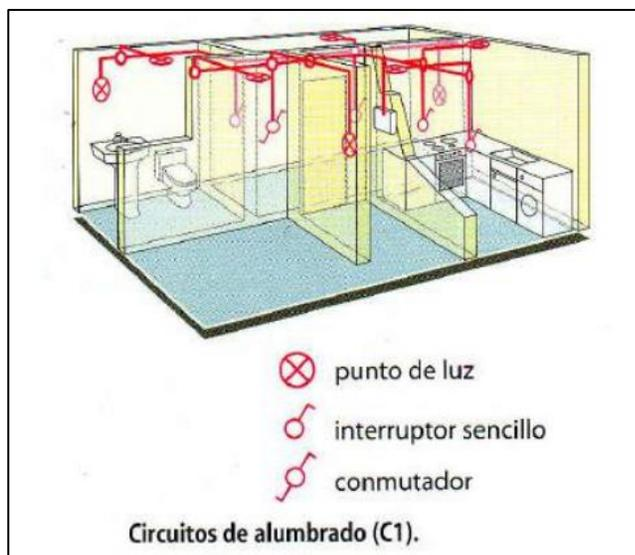
Nota. La figura muestra el diagrama de circuitos de alumbrado en una residencia.
