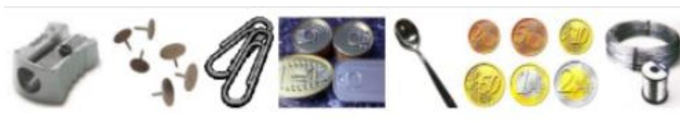
*Nota.* La figura muestra varios de los elementos conductores de electricidad.
