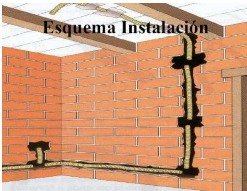
Nota. La figura muestra el esquema de instalación de un tomacorrientes, interruptor y bombilla.
