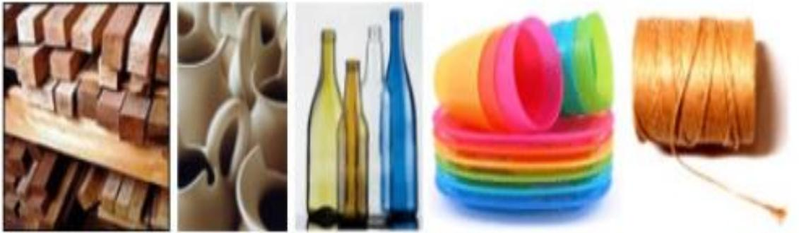
*Nota.* La figura muestra varios de los elementos no conductores de corriente eléctrica.
